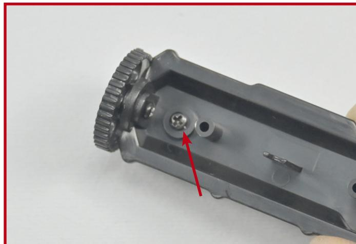
**13** Drehen Sie die Zylinderkopfhaube **7E** um. Fixieren Sie den Öl-Einfülldeckel **7F**, indem Sie eine Schraube **PS05** wie gezeigt festziehen.
