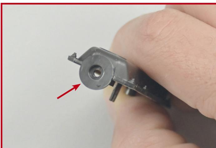
**7** Eine Seite der Zylinderkopfhaube **7E** hat eine runden Öffnung, in die das Nockenwellen-Zahnriemenrad eingesetzt werden muss.
