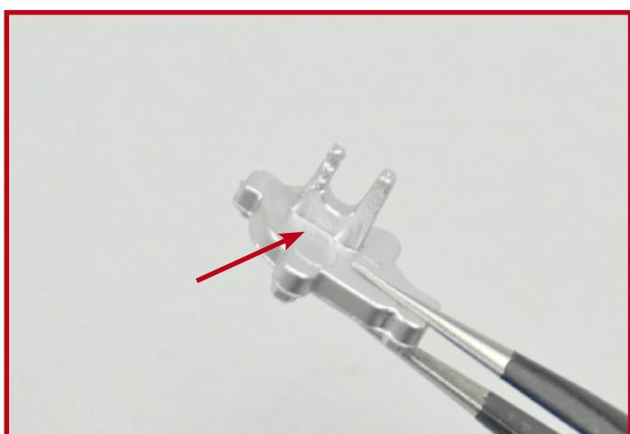
**1** Identifizieren Sie mithilfe des Fotos den gegabelten Teil an der Platte **7A**, der am Ölfilterhalter eingesetzt wird.
