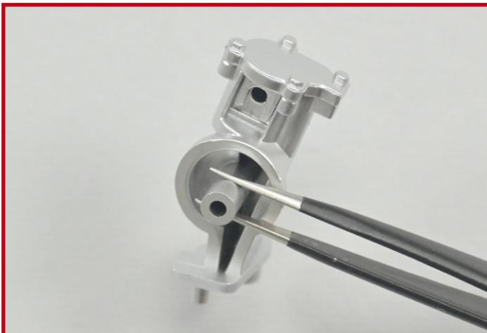
**3** Setzen Sie die Platte **7A** wie gezeigt auf den Ölfilterhalter **7C**. Die Teile werden in Schritt 6 fixiert.
