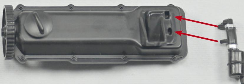
**17** Wenden Sie die Zylinderkopfhaube **7E** und platzieren Sie die Hülse **7D** wie durch die Pfeile ange deutet darauf.
