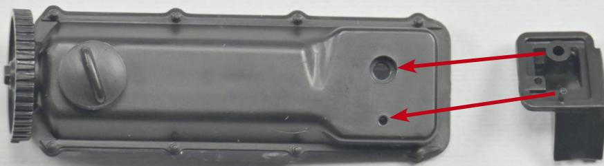
**14** Drehen Sie die Zylinderkopfhaube **7E** erneut. Setzen Sie die Halterung **7G** wie ange deutet auf die Zylinderkopfhaube.
