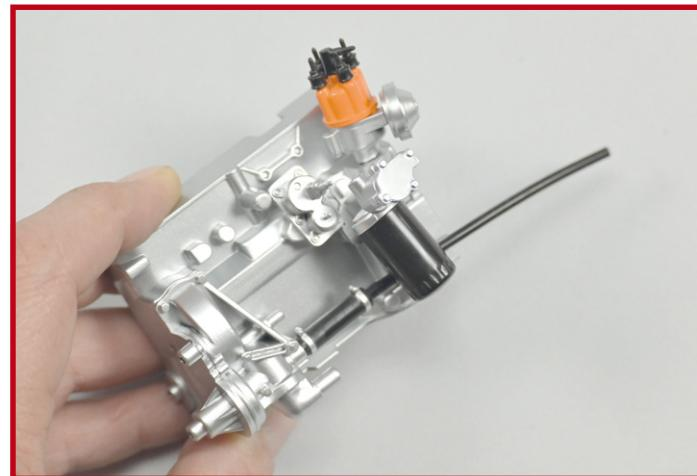
**20** Nehmen Sie die Frontseite des Motorblocks, an der Sie in Bauphase 6 gearbeitet haben. Setzen Sie den Ölfilterhalter **7C** wie angedeutet in die entsprechenden Bohrungen ein.
