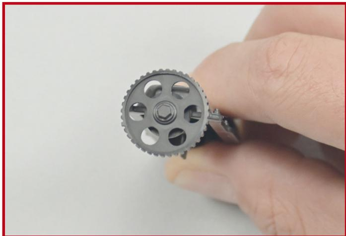
**9** Das Foto zeigt das korrekt auf der Zylinderkopfhaube **7E** platzierte Nockenwellen-Zahnriemenrad **7H**.
