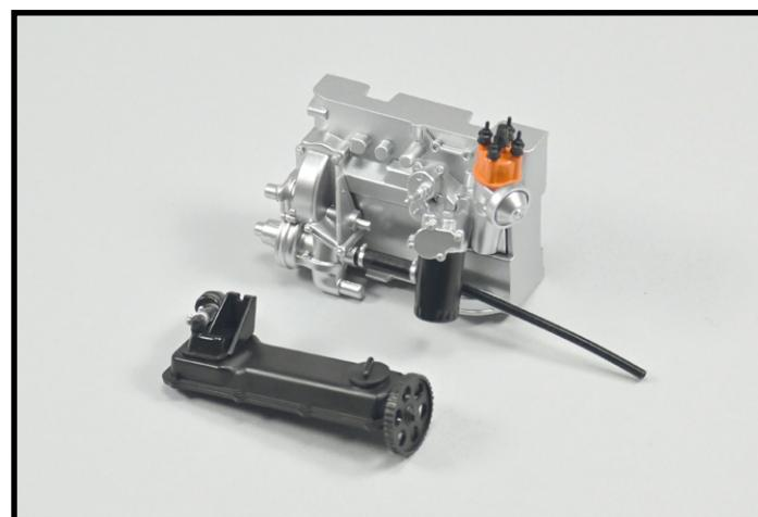
**22** Drehen Sie den Motorblock um. Ziehen Sie eine Schraube **PS36** in der Bohrung fest, auf die der Pfeil weist, um den Ölfilterhalter zu fixieren.
