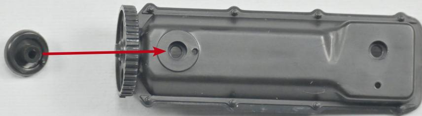
**11** Setzen Sie den Öl-Einfülldeckel **7F** wie durch den Pfeil angedeutet auf die Zylinderkopfhaube **7E**.
