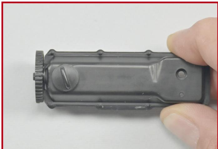
**12** So sieht der korrekt auf der Zylinderkopfhaube **7E** platzierte Öl-Einfülldeckel **7F** aus.
