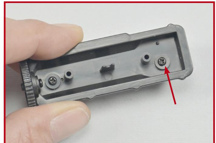
**16** Drehen Sie die Zylinderkopfhaube **7E** um und befestigen Sie die Halterung **7G** mit einer Schraube **PS05**.
