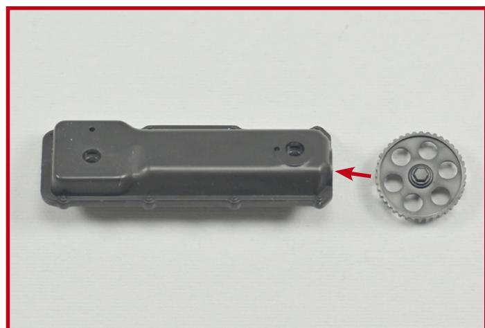
**8** Setzen Sie das Nockenwellen-Zahnriemenrad **7H** wie angedeutet auf die Zylinderkopfhaube **7E**.
