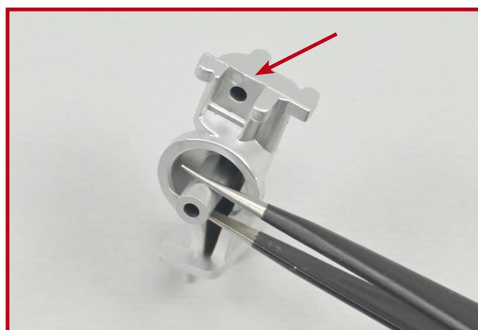
**2** Der Pfeil weist auf die Stelle des Ölfilterhalters **7C**, auf die die Platte gesetzt wird.
