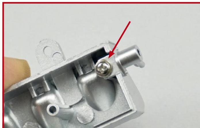
**1** Fügen Sie das Rohrstück **8D** in die Aussparung ein, die sich auf der Innenseite der vorderen Seite des Zylinderkopfs **8B** befindet, wie angedeutet.
