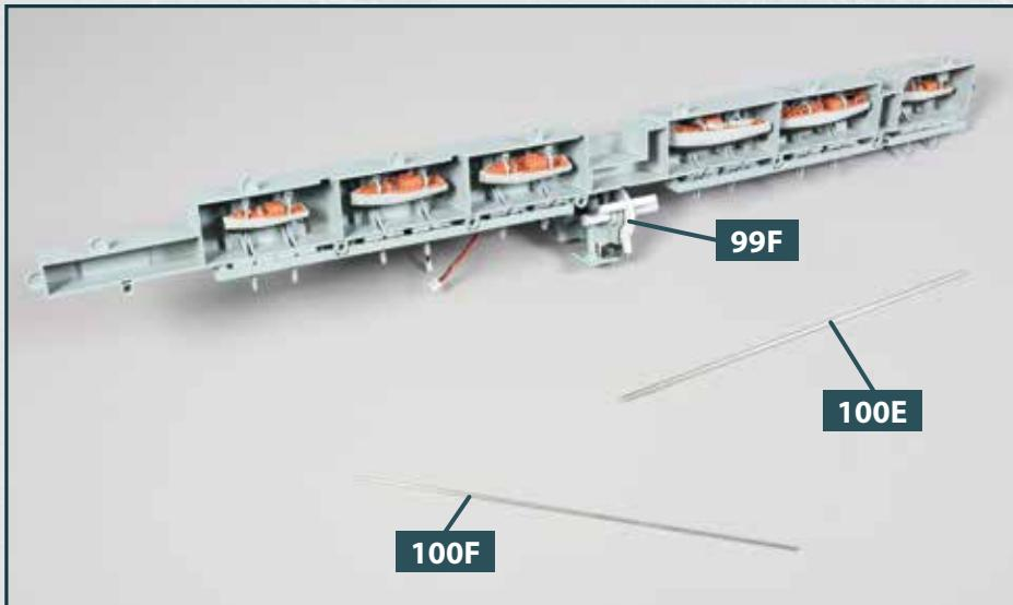
**1** Legen Sie die linken Bootsnischen auf Ihre Arbeitsplatte. Davor platzieren Sie die vordere Führungsachse **100E** und die vordere Schwenkachse **100F**. Sie werden mit den nächsten Schritten in die Aufnahmen der Achsenführung **99F** eingefügt.
