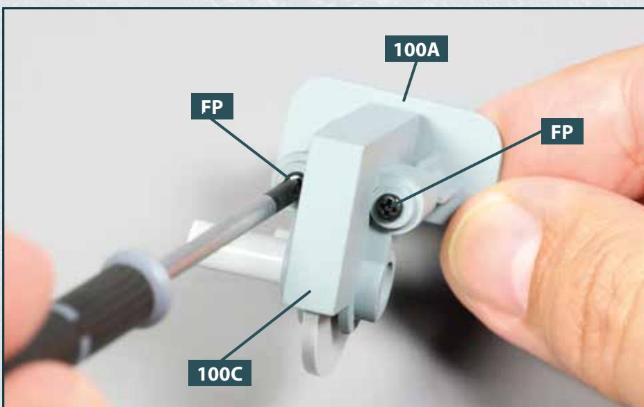
**6** Halten Sie die Bauteile in Position und drehen Sie die Baugruppe um: Fixieren Sie das Gehäuseteil **100C** an der Halterung **100A**, indem Sie die zwei Schrauben **FP** in die Schraubenlöcher hineindrehen, wie abgebildet.
