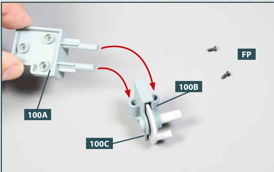
**5** Das Gehäuseteil **100B** sitzt auf dem Gehäuseteil **100C**. Nehmen Sie die Halterung **100A** und fügen Sie deren lange Zapfen in die Aufnahmen von **100B** ein, wie es die Pfeile andeuten. Legen Sie zwei Schrauben **FP** bereit.
