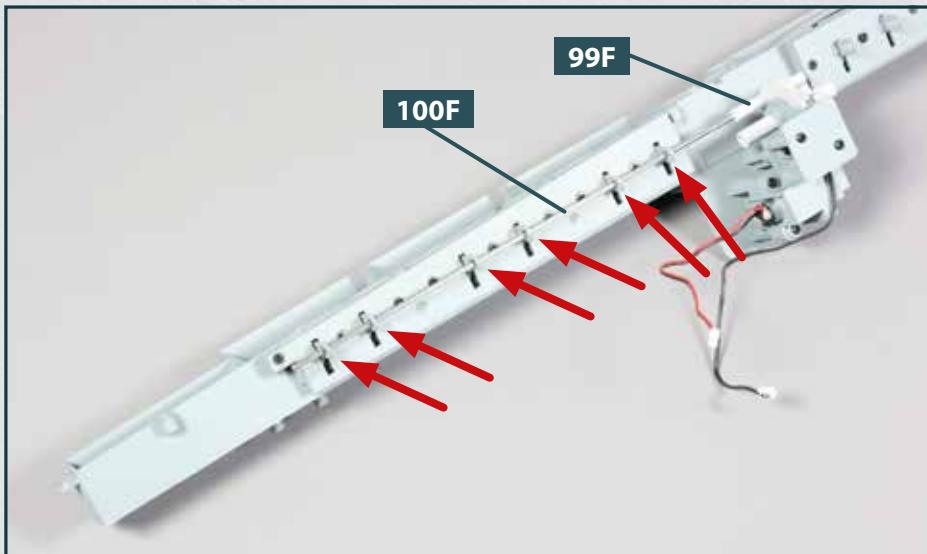
**2** Die vordere Schwenkachse **100F** wird durch die Bohrungen der sechs Schwenkdavits geführt, auf die die Pfeile weisen, und in die schmalere Aufnahme der Achsenführung **99F** hineingedrückt, wie abgebildet.
