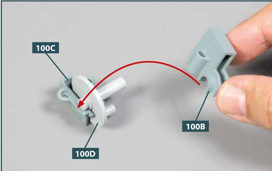
**4** Setzen Sie die Achsaufnahme **100D** in das Gehäuseteil **100C** ein. Achten Sie dabei auf die Ausrichtung der beiden Achsaufnahmen. Nehmen Sie das Gehäuseteil **100B** und platzieren Sie es auf dem Gehäuseteil **100C**, wie es der Pfeil andeutet.
