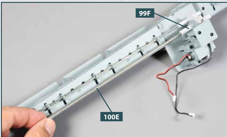
**3** Das hintere Ende der vorderen Führungsachse **100E** gehört in die breitere Aufnahme der Achsenführung **99F**, wie es das Foto zeigt.
