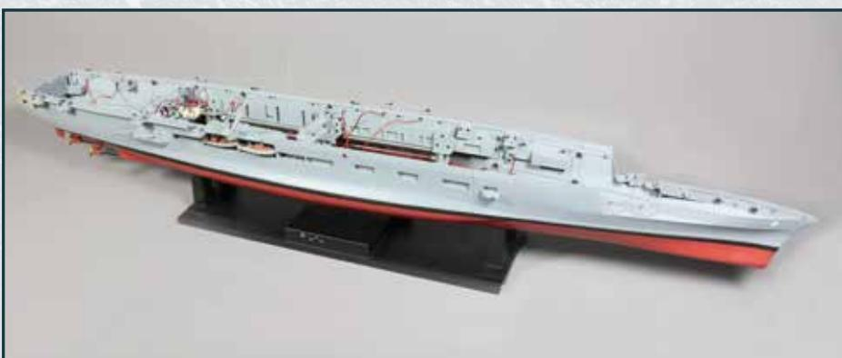
Auf der linken Rumpfseite ist ein weiterer Laufgang befestigt. Die beiden Kabel der Geschütz-LEDs sind mit einer Platine verbunden. Ein Querträger ist an der Rumpfstruktur angebracht.
