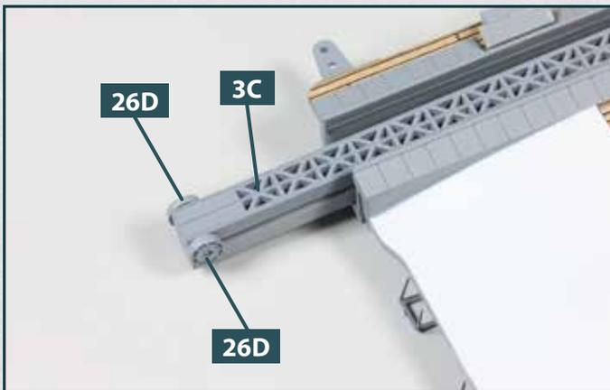
**9** Kleben Sie die beiden verbliebenen Räder **26D** mit etwas Sekundenkleber an den seitlichen Zapfen der Schleuderbahn des ersten Katapults **3C** fest.
