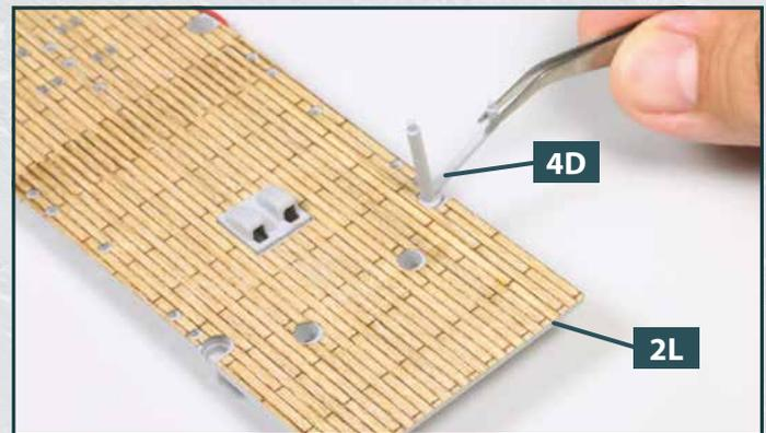
**2** Fügen Sie den Fuß vom Tragstreben-Bauteil **4D** in die große Bohrung ein, die sich am Steuerbord-Rand im hinteren Bereich des Unterdeckabschnitts **2L** befindet. **Hinweis:** Die Tragstreben werden vorerst nur provisorisch befestigt – nicht festkleben!
