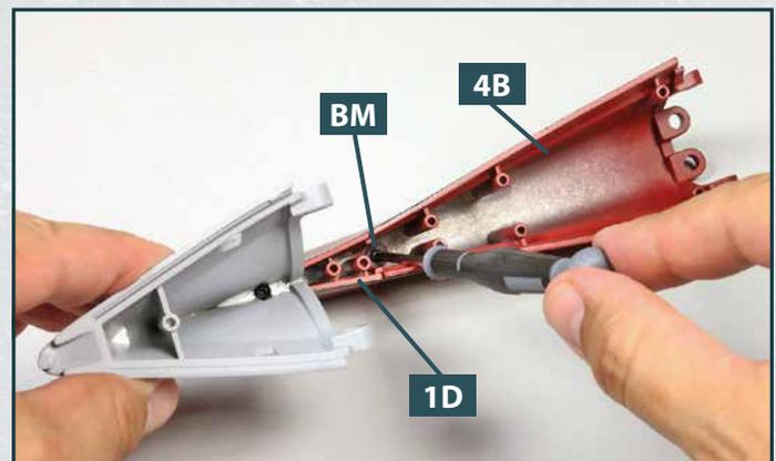
**2** Befestigen Sie den Rumpfabschnitt **1D** und den Kielabschnitt **4B** aneinander, indem Sie eine Schraube **BM** eindrehen.
