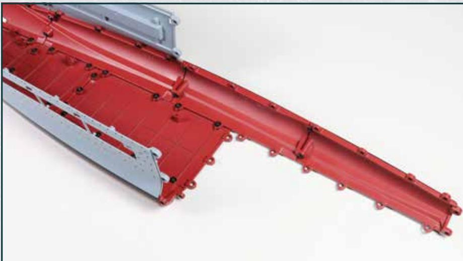
Der Kielabschnitt ist in die Rumpfstruktur eingefügt und an dieser befestigt.
