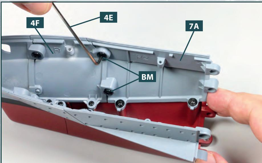
**3** Befestigen Sie den rechten oberen Rumpfabschnitt **7A** mit zwei Sechskantschrauben **BM** am Rumpfabschnitt **4F**. Verwenden Sie zum Eindrehen der Sechskantschrauben den Innensechskant **4E**.
