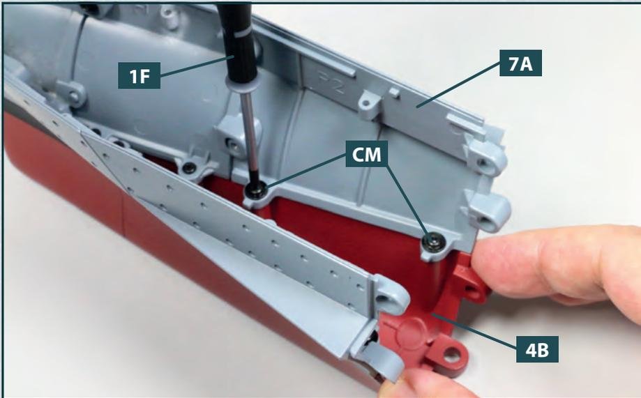
**2** Fixieren Sie den rechten oberen Rumpfabschnitt **7A** mit zwei Schrauben **CM** am Kielabschnitt **4B**. Die Kreuzschlitzschrauben werden mithilfe des Drehers **1F** festgezogen.
