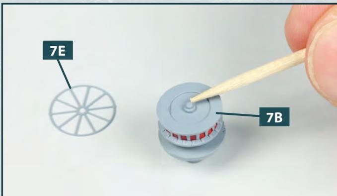
**3** Die Spilltrommel **7B** ist am Ankerspill fixiert. Versehen Sie den kleinen Zapfen an ihrer Oberseite mit einer winzigen Menge Sekundenkleber. Legen Sie den Spillkopf **7E** bereit.
