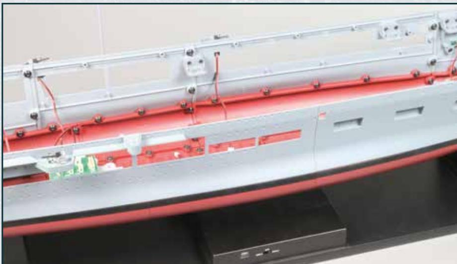
**Auf der rechten Rumpfseite ist ein weiterer Laufgang befestigt. Das Kabel der Geschütz-LED ist mit einer Platine verbunden. Auf der linken Rumpfseite ist ein Winkel montiert.**
