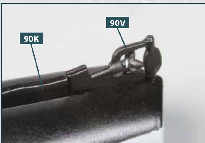
**11** Drehen Sie die Motorbarkasse um und kleben Sie das Rudergestänge **90V** in den beiden Bohrungen am Kiel des Rumpfs **90K** fest.
