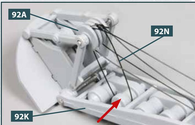
**10** Den abgeschnittenen Rest vom Kranseil **92N** führen Sie durch die mittlere, zweite Rille der Umlenkrolle **92A** und um die Trommel herum, auf die der Pfeil weist. Machen Sie an der Umlenkrolle einen Knoten und entfernen Sie den Seilüberstand.
