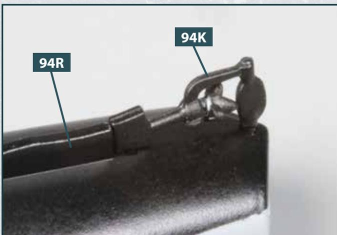
**11** Drehen Sie die Motorbarkasse um und kleben Sie das Rudergestänge **94K** in den beiden Bohrungen am Kiel des Rumpfs **94R** fest.
