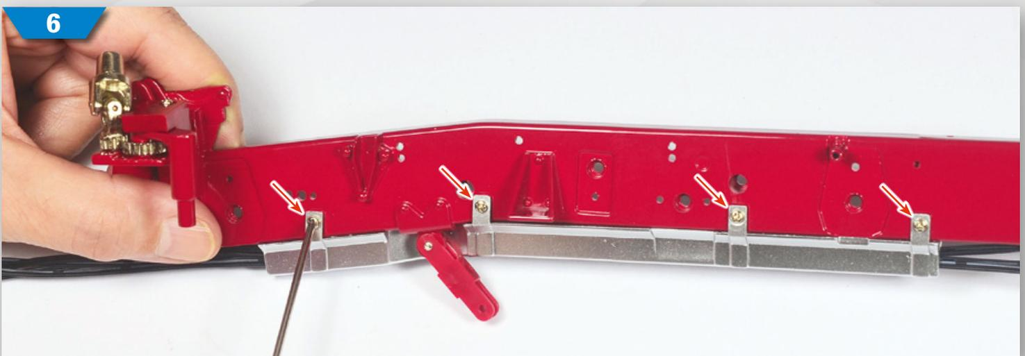
**6** Verschrauben Sie die Teile miteinander, indem Sie vier DS23-Schrauben in die auf dem Foto markierten Bohrungen eindrehen.
