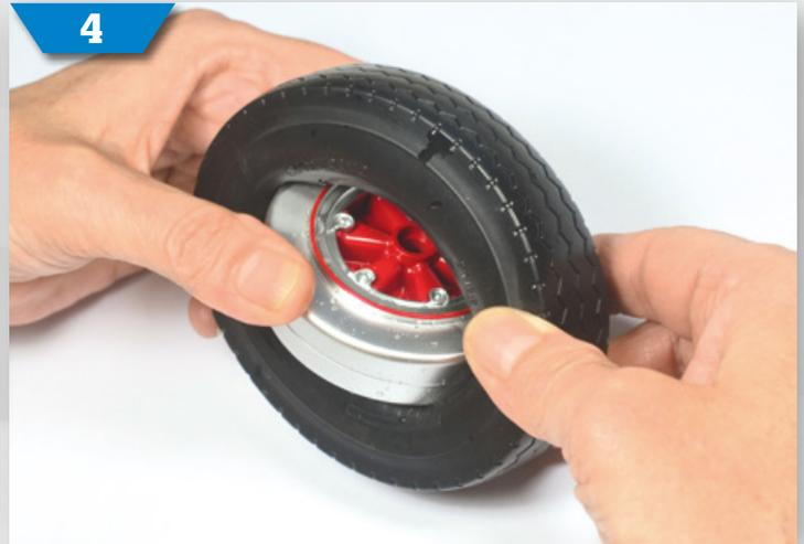
**4** Ziehen Sie den Reifen auf die Felge auf, wie auf dem Foto gezeigt. Wenn Sie fertig sind, müssen die Reifenkanten perfekt auf beide Felgenflächen passen.
