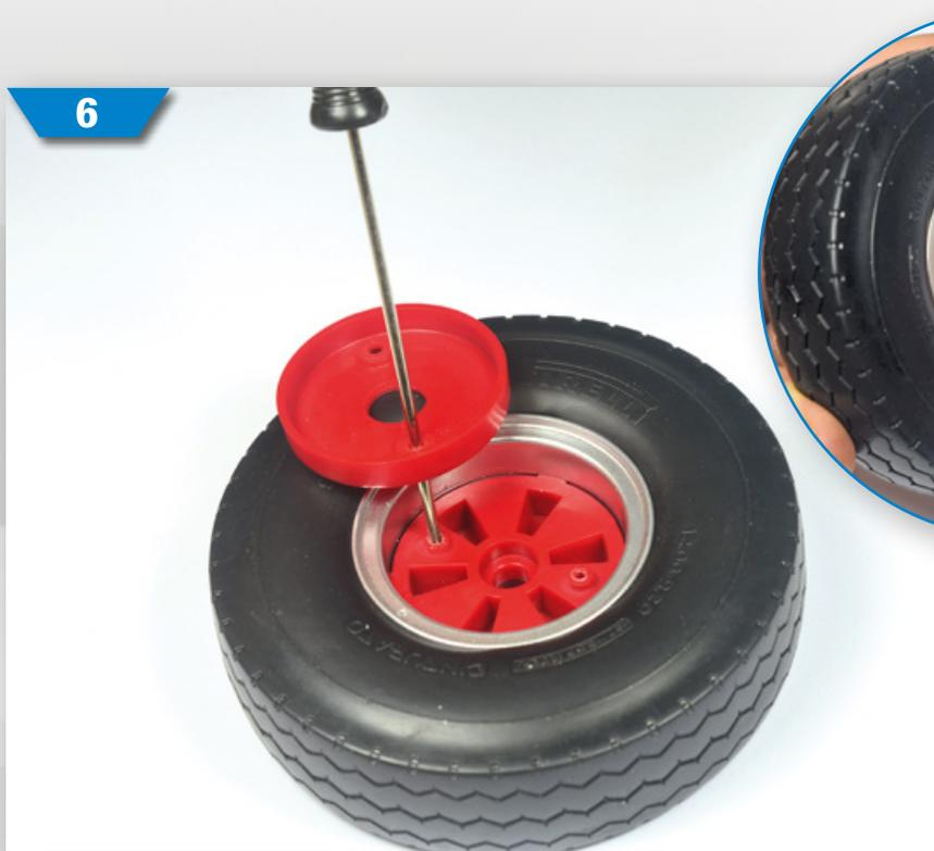
**6** Setzen Sie das Mittelteil der Felge so ins Rad, dass die zwei kleinen Löcher mit denen der Nabe fluchten. Befestigen Sie die Teile mit zwei PS02-Schrauben aneinander.
