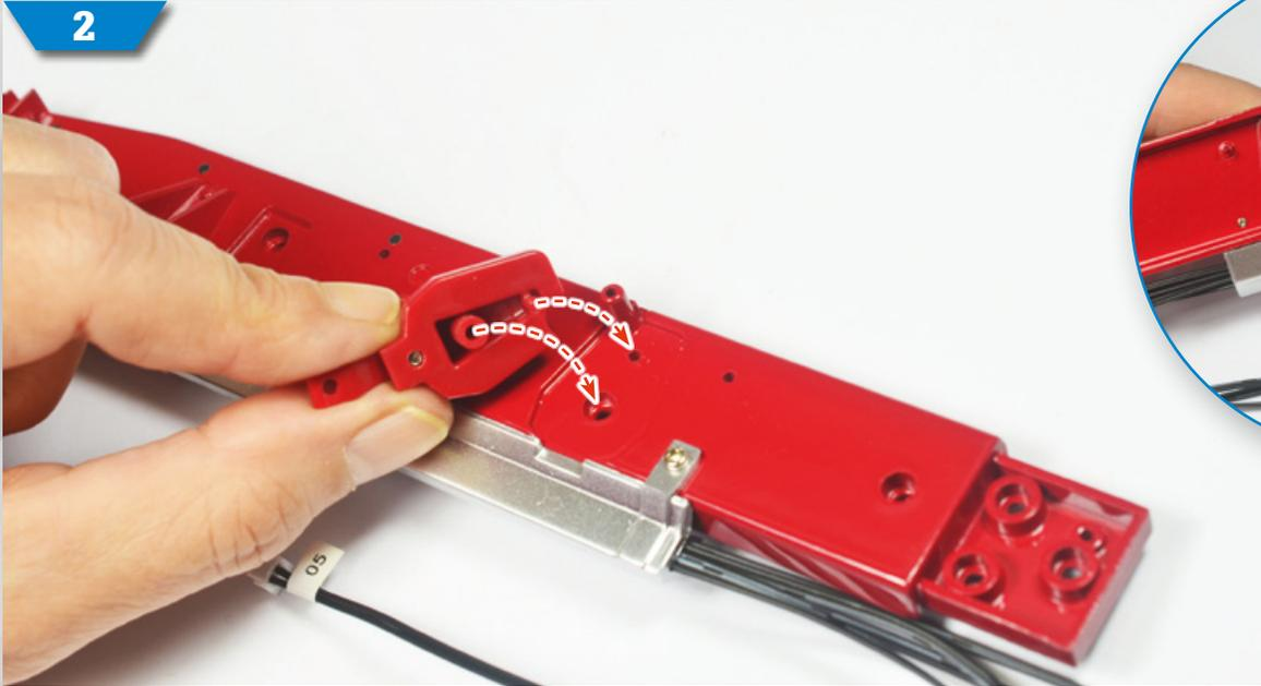
**2** Nehmen Sie den vorderen linken Querträger des Fahrgestells der Zugmaschine, den Sie in Bauphase 47 bearbeitet haben, wieder zur Hand. Positionieren Sie die hintere Federhalterung an der dafür vorgesehenen Stelle am Querträger, wie auf dem Foto gezeigt. Drehen Sie den Querträger um und verschrauben Sie die Teile mit einer PS02-Schraube.
