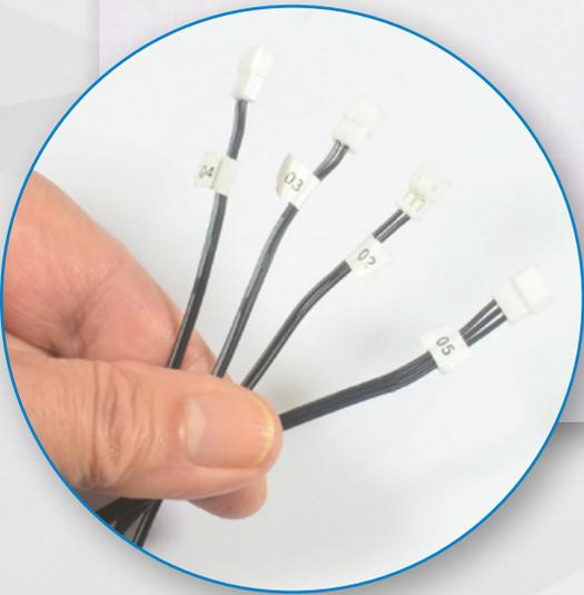
**2** Führen Sie die Kabel 02, 03, 04 und 05 in den Kabelkanal ein und richten Sie sie wie auf dem Foto gezeigt aus: Die Enden der Kabel mit den größeren Steckern müssen ca. 7 cm über den gebogenen Abschnitt des Kabelkanals hinausragen.
