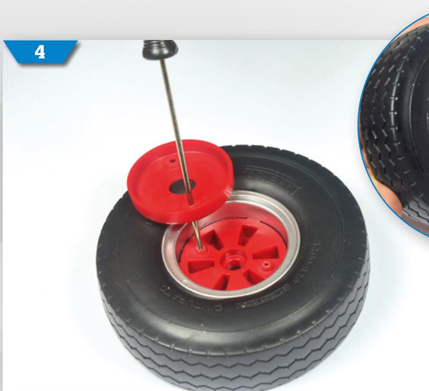
**4** Setzen Sie das Mittelteil der Felge so ins Rad, dass die zwei kleinen Löcher mit denen der Nabe fluchten. Befestigen Sie die Teile mit zwei PS02-Schrauben aneinander.
