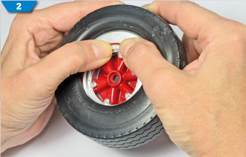
**2** Lassen Sie den Reifen einige Minuten lang in heißem Wasser einweichen, damit er weicher wird, und setzen Sie die Felge ein. Nehmen Sie den Reifen aus dem Wasser und setzen Sie die Felge in den Reifen ein. Wenn Sie fertig sind, müssen die Reifenkanten perfekt auf beide Felgenflächen passen.
