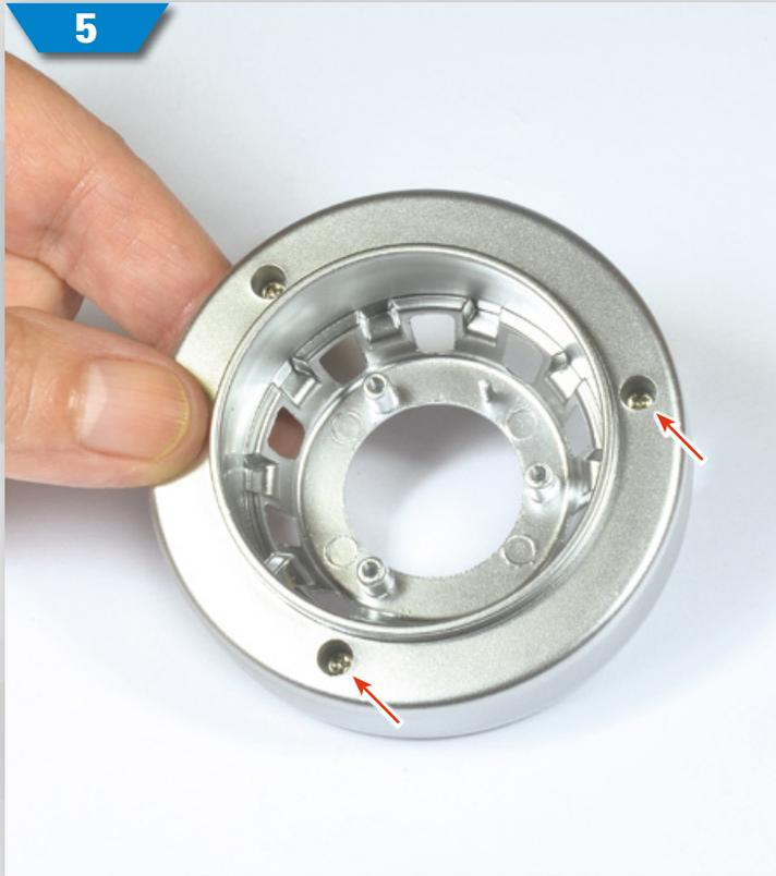
**5** Setzen Sie nun die restlichen DS01-Schrauben in die verbleibenden Löcher ein und ziehen Sie alle Schrauben fest.
