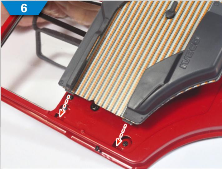
**6** Beginnen Sie mit den beiden Laschen an der kürzeren Seite des Panels, sie werden in die entsprechenden Schlitz in der Tür eingeführt. Achten Sie darauf, dass Sie den Seitenspiegel bei diesem Vorgang nicht beschädigen.
