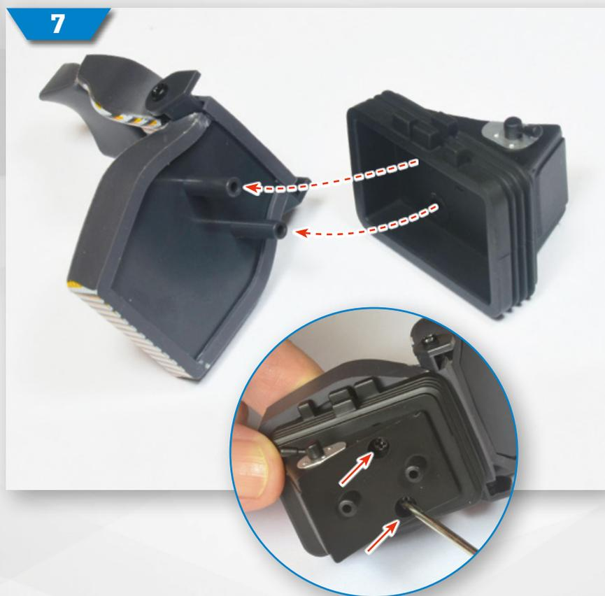
**7** Befestigen Sie den Sitz an der Halterung und richten Sie die Teile wie gezeigt aus. Ziehen Sie beiden PS05-Schrauben in den durch die Pfeile im Kreis markierten Löchern fest, um die Bauteile miteinander zu verbinden.
