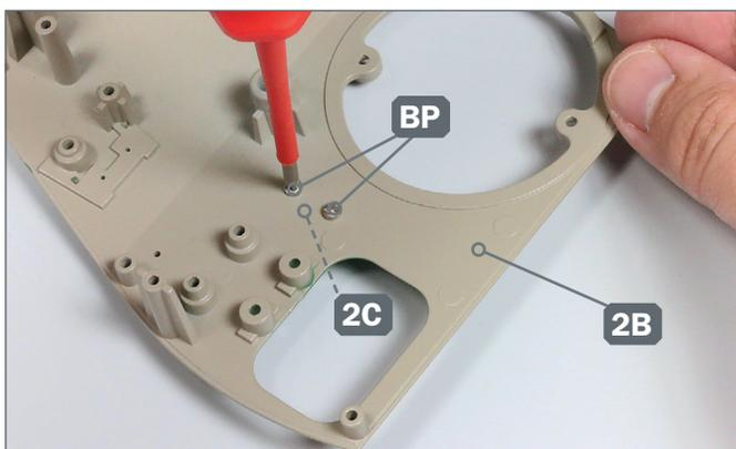
**5** ▶ Halten Sie die Panzerscheibe 2C in Position und drehen Sie das Turmdach 2B um. Fixieren Sie die Panzerscheibe 2C mit zwei Schrauben BP.
