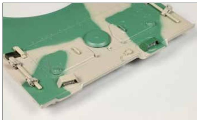
**6** ▶ Die beiden Winkelspiegel und deren Abdeckungen in der Übersicht: links im Bild der Funkerspiegel, rechts der Spiegel, durch den der Fahrer blickte.
