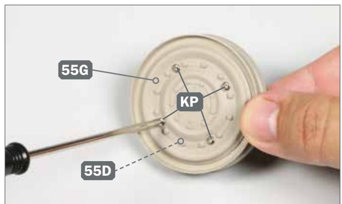
**6** ► Fixieren Sie die beiden Laufrad-Baugruppen 55G und 55D aneinander, indem Sie die vier Schrauben KP an der Außenseite des inneren Laufrads eindrehen.
