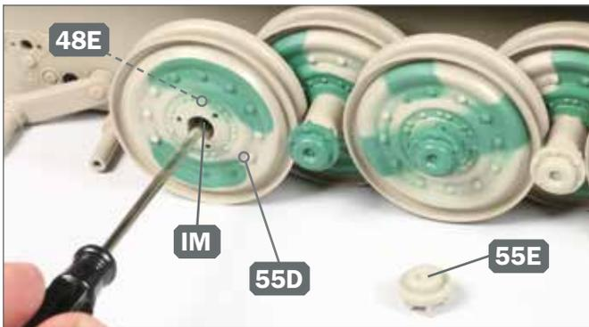
**7** ▶ Legen Sie den Nabendeckel 55E bereit. Setzen Sie das Laufrad 55D auf den dritt Vordersten Achsschenkel 48E und befestigen Sie es mit einer Schraube IM.
