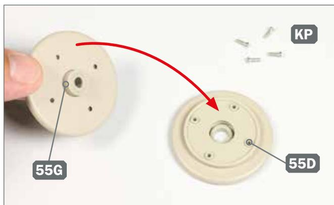
**5** ► Fügen Sie die beiden Laufrad-Baugruppen 55G und 55D zusammen, wie es der Pfeil andeutet. Legen Sie vier Schrauben KP bereit.
