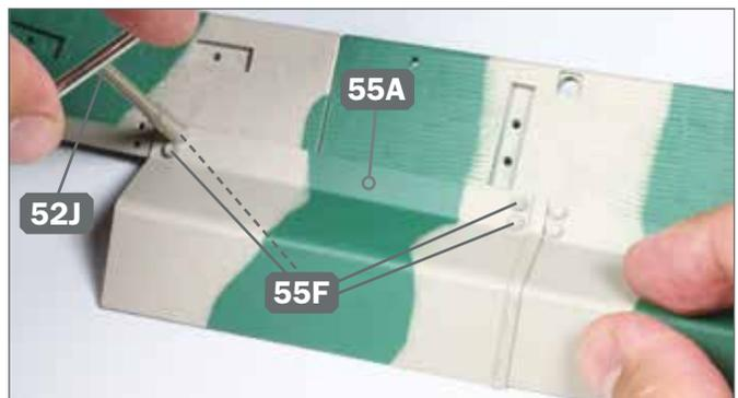
**2** ▶ Befestigen Sie den Kettenschutz 55A mit den vier dunkelgelben Schrauben 55F an der Seitenwand. Zum Festziehen verwenden Sie den Sechskant-Steckschlüssel 52J, wie es das Foto zeigt.
