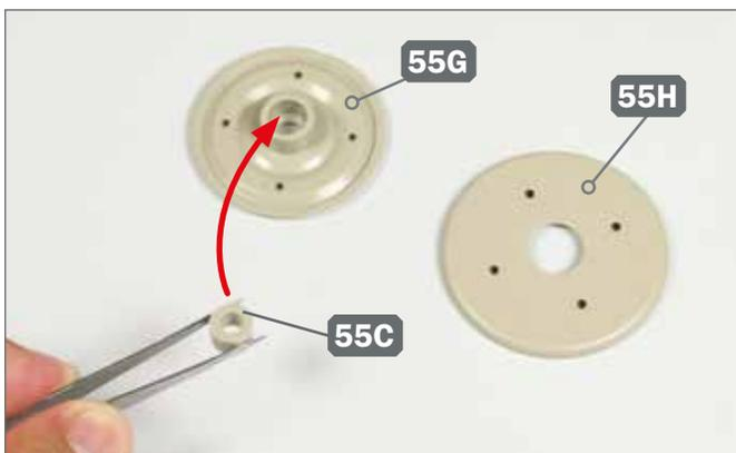
**3** ► Legen Sie das innere Laufrad 55G und die Lochscheibe 55H bereit. Führen Sie die Manschette 55C zur Nabe an der Innenseite des Laufrads 55G.
