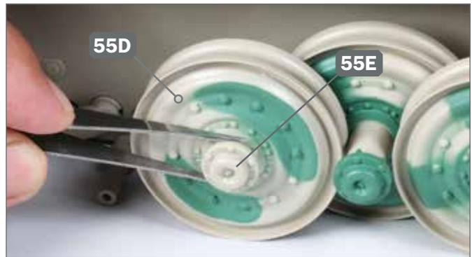
**8** ▶ Befestigen Sie den Nabendeckel 55E am Laufrad 55D: Drücken Sie dafür die drei Zapfen des Deckels vorsichtig in die drei Bohrungen des Laufrads.
