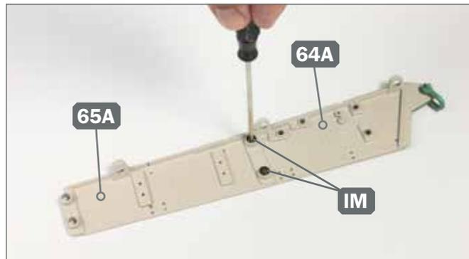
**2** ▶ Befestigen Sie die beiden Wannenseitenteile 64A und 65A aneinander, indem Sie an deren Innenseiten zwei Schrauben IM eindrehen, wie abgebildet
