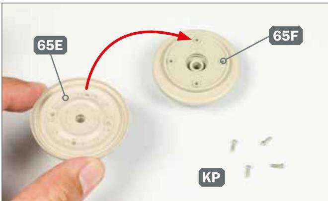
**5** ▶ Nehmen Sie die innere Laufrad-Baugruppe 65E und fügen Sie sie mit der äußeren Laufrad-Baugruppe 65F zusammen. Legen Sie vier Schrauben KP bereit.
