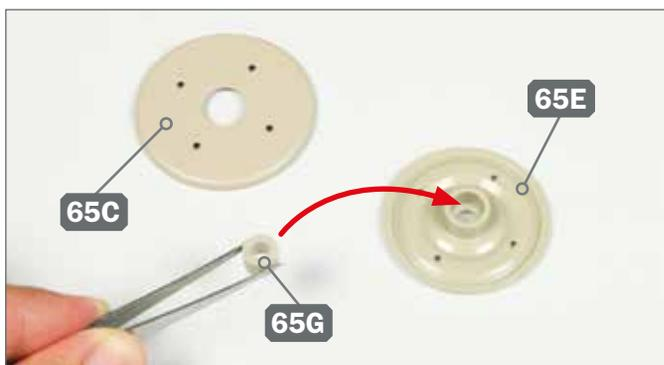
**3** ▶ Legen Sie das innere Laufrad 65E und die Lochscheibe 65C bereit. Führen Sie die Manschette 65G zur Nabe des Laufrads 65E, wie angedeutet.
