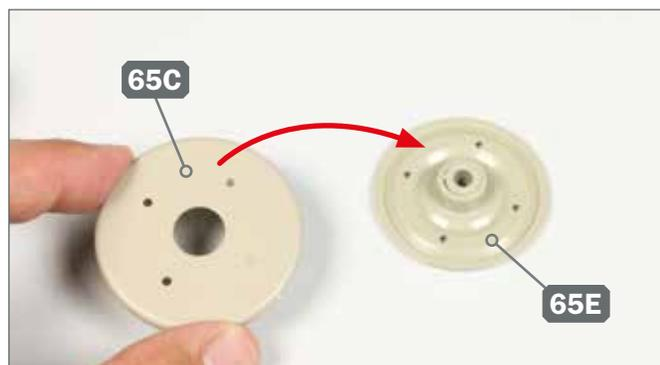
**4** ▶ Nehmen Sie die Lochscheibe 65C und setzen Sie sie auf das innere Laufrad 65E, wie angedeutet.
