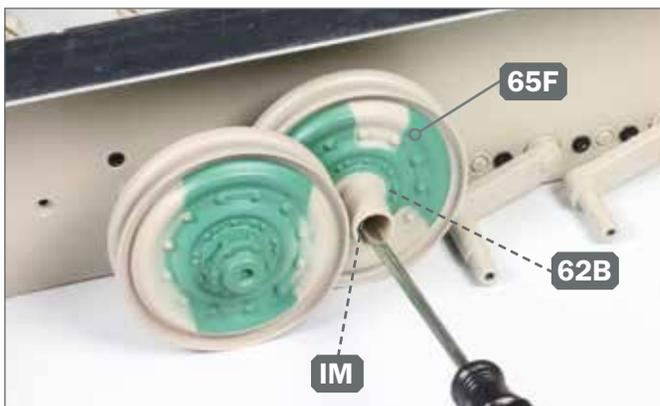
**7** ▶ Platzieren Sie das Laufrad 65F auf dem zweithintersten Achsschenkel 62B und befestigen Sie es mit einer Schraube IM, wie abgebildet.
