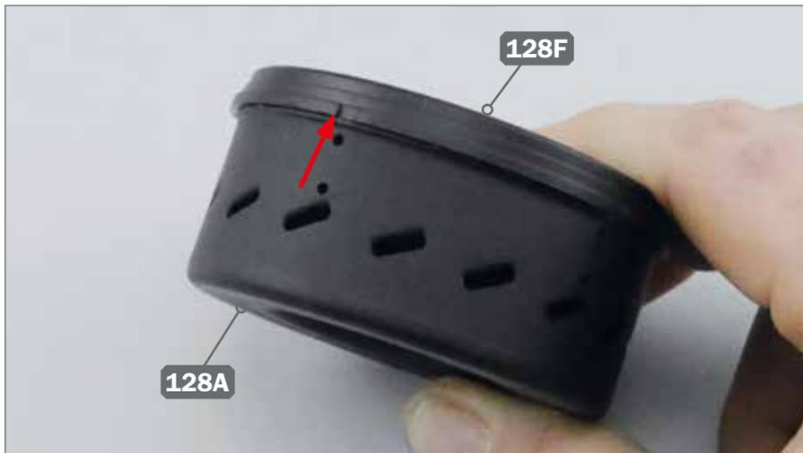
**7** ▶ Richten Sie die Aussparungen an der Abdeckung 128F wie durch den Pfeil angezeigt an den Lochpaaren am Filtergehäuse 128A aus.
