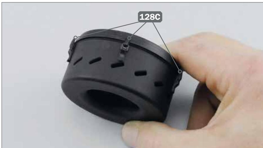
**8** ▶ Setzen Sie die fünf Verschlüsse 128C in die Aussparungen und Löcher ein. Gegebenenfalls können Sie vor dem Einsetzen ein wenig Sekundenkleber auf die Stifte auftragen.
