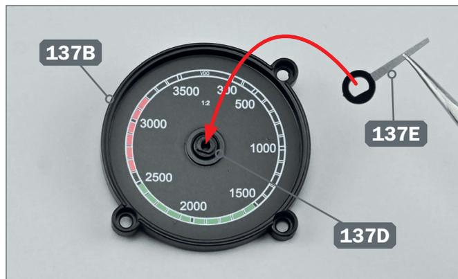
**2** ► Drehen Sie den Drehzahlmesser 137B auf den Kopf und achten Sie darauf, dass die Halterung 137D dabei nicht herausfällt. Setzen Sie die Öffnung des Zeigers 137E auf die Halterung. Die schwarze Fläche des Zeigers muss nach unten zeigen.
