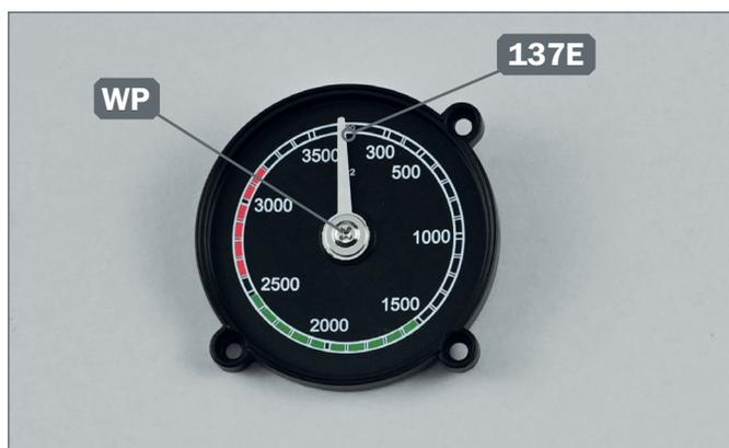
**3** ► Befestigen Sie den Zeiger 137E mit einer Schraube WP an der Halterung.
