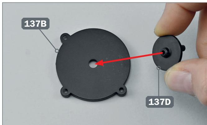
**1** ► Stecken Sie den gelochten Stift der Halterung 137D in das Loch in der Mitte der Rückseite des Drehzahlmessers 137B.
