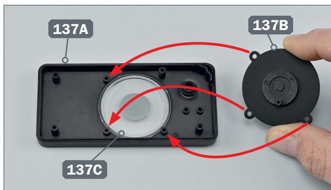
**5** ► Montieren Sie den Drehzahlmesser 137B an der Innenseite der Steuerplatte 137A auf den Deckel 137C, indem Sie die Teile wie abgebildet ausrichten. Die Öffnungen des Drehzahlmessers müssen mit den gebohrten Stiften der Steuerplatte übereinstimmen.
