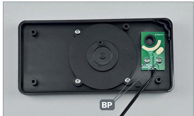
**7** ▶ Setzen Sie die Leiterplatte mit Kabel 137F wie gezeigt an der Innenseite der Vorderseite der Steuerplatte 137A ein.
