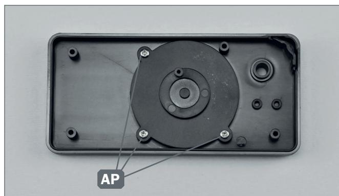
**6** ► Befestigen Sie den Drehzahlmesser mit drei Schrauben AP an der Steuerplatte.
