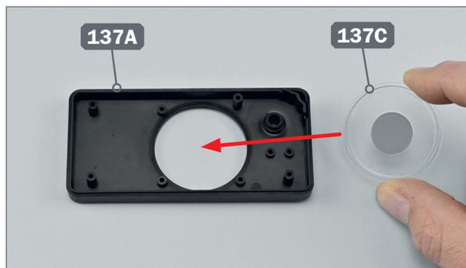
**4** ► Setzen Sie den Deckel 137C in das entsprechende Loch auf der Innenseite der Vorderseite der Steuerplatte 137A ein. Richten Sie die Teile wie auf dem Foto gezeigt aus.
