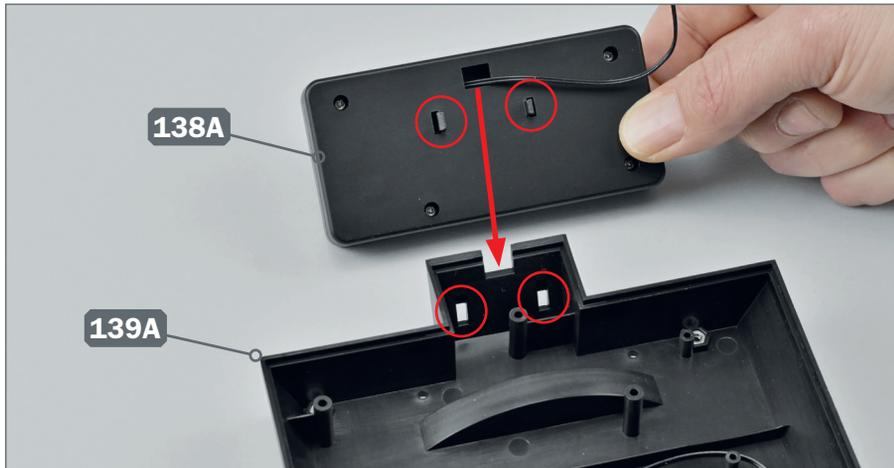
**1** ▶ Nehmen Sie die Steuerplatte Ihres Modells zur Hand. Richten Sie sie wie auf dem Foto gezeigt aus und verbinden Sie sie mit dem Sockel 139A, indem Sie die beiden Laschen an der Rückseite der Steuerplatte 138A in die rechteckigen Öffnungen des hervorstehenden Teils des Sockels einführen. Die Öffnung der Steuerplatte, aus der das Kabel herausragt, muss mit der quadratischen Aussparung des Sockels übereinstimmen.
