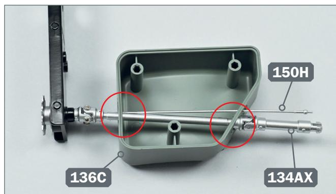
**8** ▶ Führen Sie das Ende der neuen Antriebswelle 134AX und das Ende des Stabs 150H durch die Löcher im Außenteil 136C. Richten Sie die Teile wie auf dem Foto gezeigt aus.
