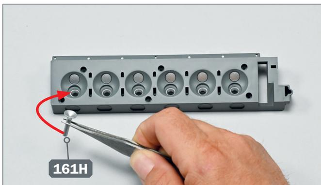
**3** ▶ Drehen Sie die Gruppe um und setzen Sie von der Außenseite des Motorkopfes aus ein Teller Ventil 161H in eine der entsprechenden Vertiefungen ein, die sich auf der Stützplatte befinden.
