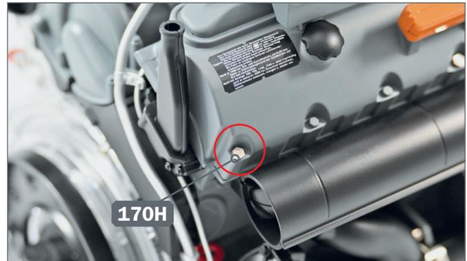
**10** ▶ Beginnen Sie mit der Befestigung der Zylinderkopf-abdeckung, indem Sie den Befestigungsstift 170H in das auf dem Foto durch den Kreis angezeigte Loch einführen.
