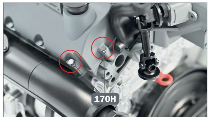
**12** ▶ Führen Sie die verbleibenden zwei Befestigungsstifte 170H in die auf dem Foto durch Kreise markierten Löcher ein, um die Befestigung der Zylinderkopf-abdeckung abzuschließen.
