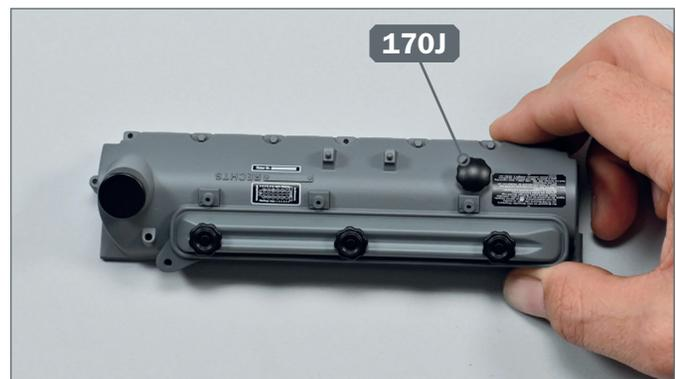
**4** ► Installieren Sie dann den großen Stöpsel 170J in die entsprechende Vertiefung auf der Oberseite der Zylinderkopfabdeckung.
