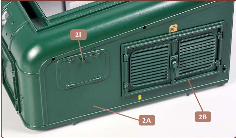
**10** Kleben Sie den Rahmen **2B** an der Schutzaube **2A** fest, wie abgebildet. Anschließend nehmen Sie einen der zwei Anschläge **2I** und kleben ihn in der kleinen Bohrung etwas weiter vorne auf der linken Seite der Schutzaube fest.
