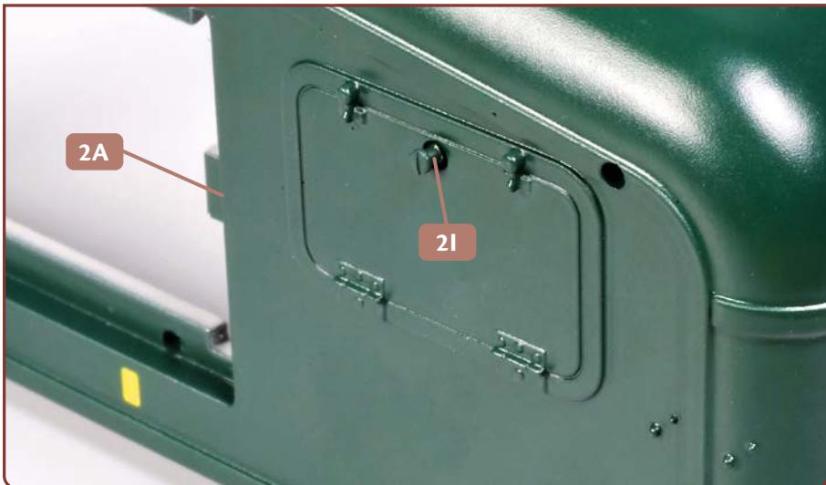
**11** Wechsel auf die rechte Seite der Schutzaube **2A**: Hier wird an der gleichen Stelle wie gegenüber der zweite Anschlag **2I** angebracht.
