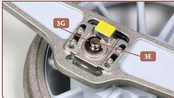
**7** Drehen Sie den Aufsteckschlüssel entlang seiner Längsachse um 180°, sodass sich der Sprengring **3G** unten befindet und befestigen Sie ihn an der Nut des Treibzapfens **3E**, wie abgebildet.
