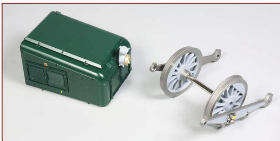
**Auf der rechten Seite der vorderen Schutzhaube haben Sie einen Rahmen mit zwei Lüftungsgittern montiert. Der erste Treibradsatz ist zusammengefügt.**
