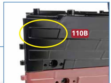
**4** Legen Sie die vier Abdeckungen **110B**, **110C**, **110D** und **110E** bereit. Das Foto oben zeigt die Position der vier Teile an der Steuerbordseite des Hecks genau an. Nehmen Sie die Abdeckung **110B** und beachten Sie, dass die beiden Zapfen unterschiedlich groß und leicht angeschrägt sind (rechts eingekreist): Drücken Sie die Zapfen in die entsprechenden Aufnahmen hinein.
