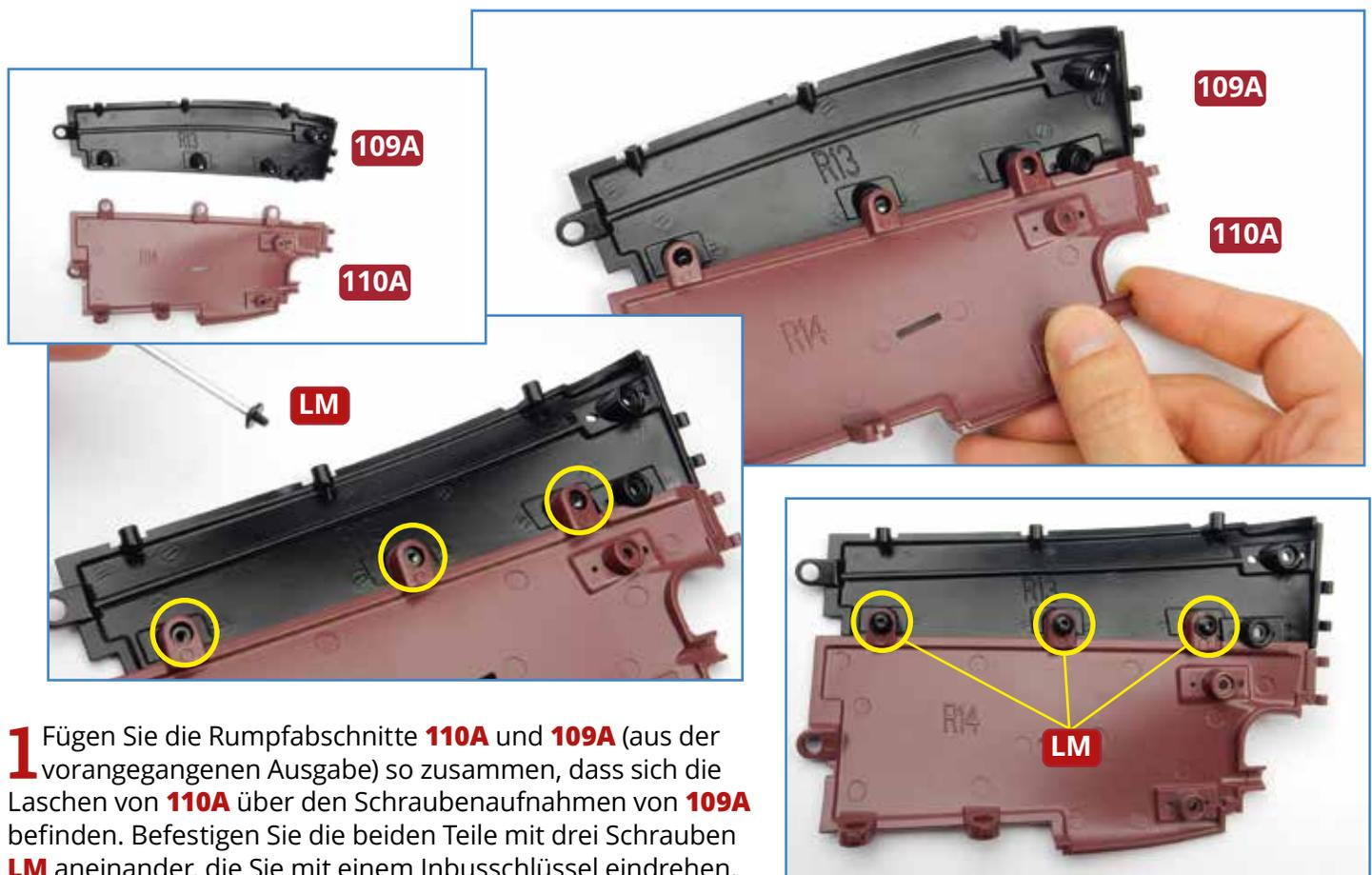
**1** Fügen Sie die Rumpfabschnitte **110A** und **109A** (aus der vorangegangenen Ausgabe) so zusammen, dass sich die Laschen von **110A** über den Schraubenaufnahmen von **109A** befinden. Befestigen Sie die beiden Teile mit drei Schrauben **LM** aneinander, die Sie mit einem Inbusschlüssel eindrehen.
