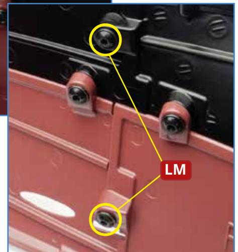
**2** Setzen Sie die zusammengeführten Rumpfabschnitte **109A** und **110A** auf der Steuerbordseite des Hecks in die Rumpfstuktur ein (ganz oben). Die Laschen der Abschnitte gehören über die Aufnahmen der Rumpfabschnitte **100A** und **99A** (oben). Befestigen Sie die Baugruppen mit zwei Schrauben **LM** aneinander (rechts). Verwenden Sie dazu wieder einen Inbusschlüssel.
