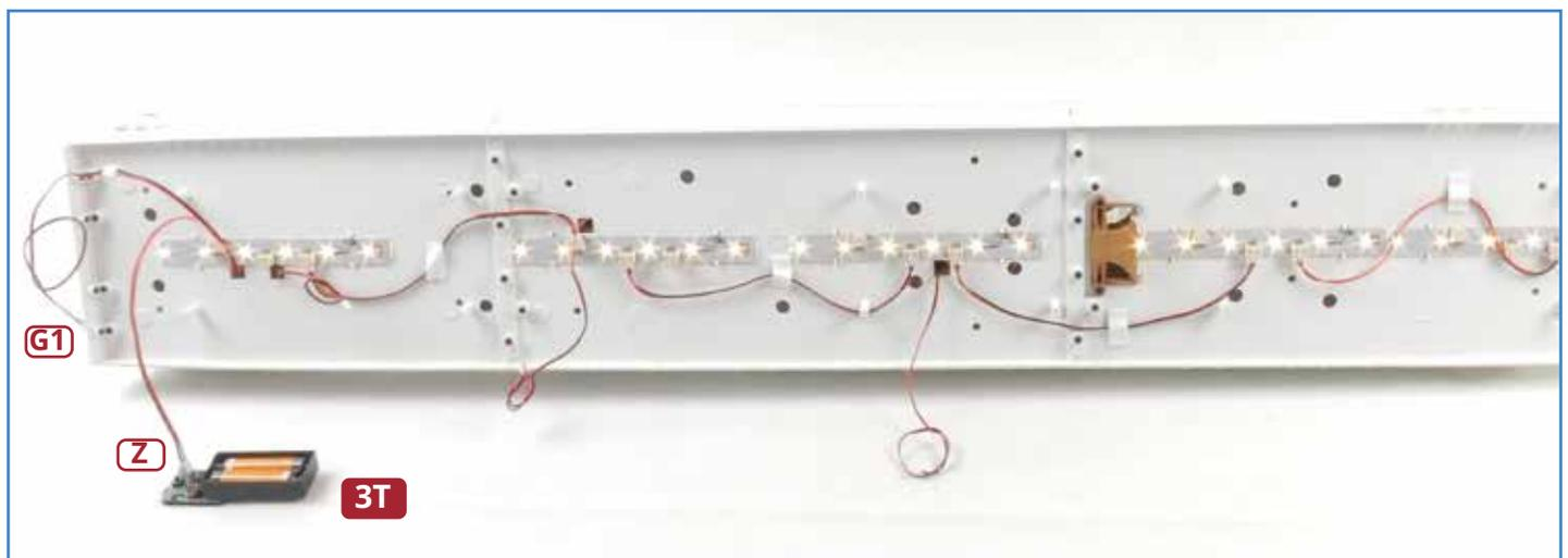
**6** Wenn die drei Decks aneinander befestigt sind, prüfen Sie noch einmal, dass die LEDs funktionieren. Verbinden Sie dazu nacheinander die beiden Stecker mit den Markierungen „G1“ und „Z“ mit dem Tester **3T**.
