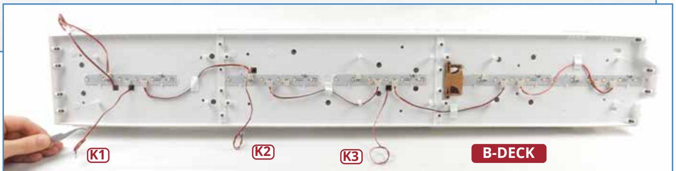
**4** Positionieren Sie das Bootsdeck neben dem zusammengebauten Promenaden-B-Deck und führen Sie die Kabel mit den Markierungen „K1“, „K2“ und „K3“ durch die rechteckigen Öffnungen des Promenaden-B-Decks (ganz
