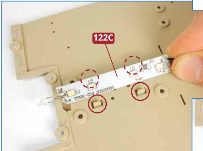
**8** Nehmen Sie den LED-Streifen **122C** und verbinden Sie dessen Stecker testweise mit dem Tester **3T**, um zu prüfen, ob alle LEDs aufleuchten. Trennen Sie das Kabel wieder und bringen Sie den LED-Streifen auf der Unterseite des achteren C-Decks **122B** auf die bereits hinlänglich bekannte Weise an.
