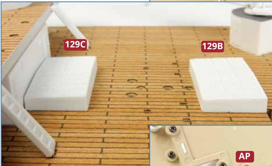
**6** Legen Sie die beiden Luken **129B** und **129C** bereit. Platzieren Sie die Luke **129B** auf dem achteren C-Deck **122B** und fixieren Sie sie von unten mit zwei Schrauben **AP** (oben). Etwas weiter achtern wird die Luke **129C** mit zwei weiteren Schrauben **AP** am C-Deck befestigt (unten).
