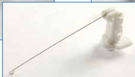
**2** Richten Sie den Kranausleger **129E** so aus, dass die Bohrungen an dessen breitem Ende mit der Bohrung des Krankkörpers **129G** fluchten. Führen Sie den langen Scharnierstift **129K** mit der glatten Seite voran durch die Bohrungen (links unten). Eine kleine Zange hilft dabei, den Stift in seine Endposition zu drücken (unten).
