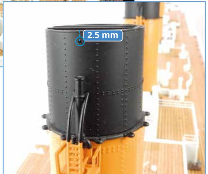
**6** Legen Sie den Rahmen mit den Mastringen **138A** bereit und trennen Sie einen Ring **V** heraus. Kleben Sie ihn über dem bereits montierten Ring **A** am Fockmast fest. Bohren Sie anschließend mit dem Handbohrer **132H** ein Loch an der Vorderseite des vordersten Schornsteins, 2,5 mm von der Oberkante der Schornsteinkappe entfernt.
