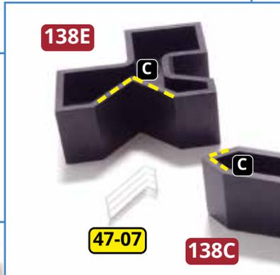
**7** Trennen Sie die Relings **47-04**, **47-05**, **47-06** und **47-07** aus dem Ätzteilrahmen **139F** heraus. Biegen Sie die Teile mithilfe der Winkel **J**, **D**, **H** und **C** der abgebildeten Schablonen. Kleben Sie die Relings auf der Steuerbordseite zwischen dem zweiten und dritten Schornstein fest. Trennen Sie vier Handläufe **44-49** aus dem Rahmen heraus und bringen Sie sie beiderseits der zwei abgebildeten Niedergänge an.
