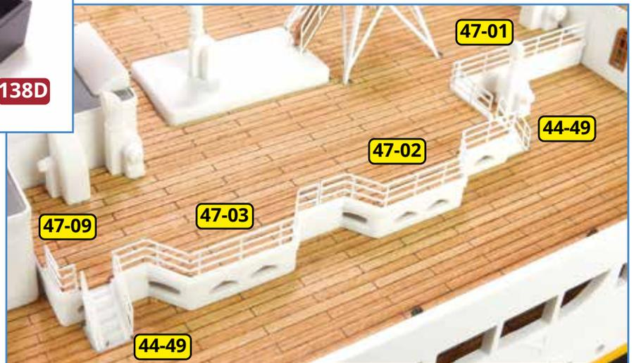
**8** Trennen Sie die Relings **47-01**, **47-02**, **47-03** und **47-09** aus dem Rahmen **139F** heraus. Biegen Sie die Teile mithilfe der Winkel **C**, **J** und **G** der abgebildeten Schablonen. Kleben Sie die Relings auf der Backbordseite zwischen dem zweiten und dritten Schornstein fest, wie rechts gezeigt. Auch hier werden vier Handläufe **44-49** an den beiden Niedergängen befestigt.
