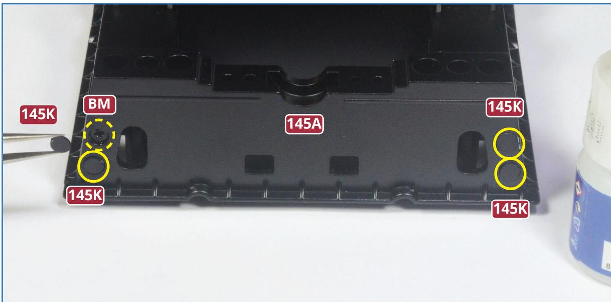
**3** Legen Sie die vier Abdeckkappen **145K** bereit. Versehen Sie die Innenseiten mit einem kleinen Tropfen Sekundenkleber und fixieren Sie die Kappen über den Schrauben **BM** (gelb eingekreist).
