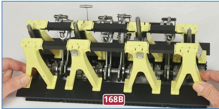
**8** Drehen Sie die Baugruppe vorsichtig um und befestigen Sie die Basis **168B** am Bodenteil, indem Sie zunächst acht Schrauben **RP** eindrehen (unten gelb eingekreist) und anschließend acht Schrauben **QP** (ganz unten weiß eingekreist).
