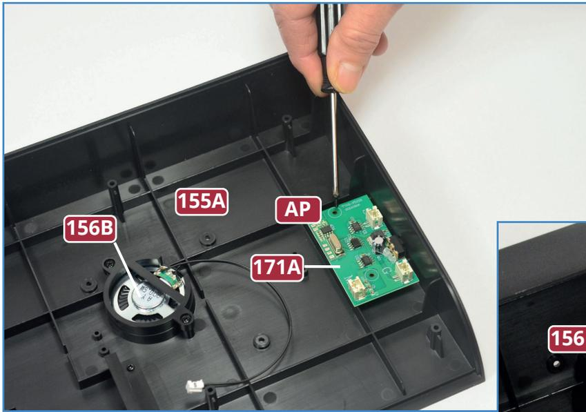
**2** Fixieren Sie die Platine **171A** mit zwei Schrauben **AP** an der Basis **155A**. Verbinden Sie den Stecker vom Lautsprecherkabel **156B** mit dem Port „S“ der Platine (auf den drei Fotos unten weiß eingekreist).
