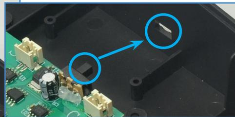
**1** Legen Sie die Basis der Maschine **155A** auf Ihre Arbeitsplatte. Positionieren Sie die Hauptplatine **171A** so auf der Unterseite der Basis, dass ihre (gelb eingekreisten) Löcher mit den (weiß eingekreisten) erhöhten Schraubenaufnahmen fluchten. Ist die Platine korrekt platziert, sitzt ihr Ein-/Aus-Schalter in der seitlichen Öffnung der Basis (oben und unten blau eingekreist).
