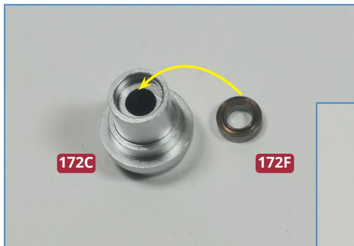
**1** Legen Sie die Wellenhalterung **172C** und eins der Gleitlager **172F** bereit. Fügen Sie das Lager in die Aufnahme der Halterung ein, wie es die Fotos zeigen.
