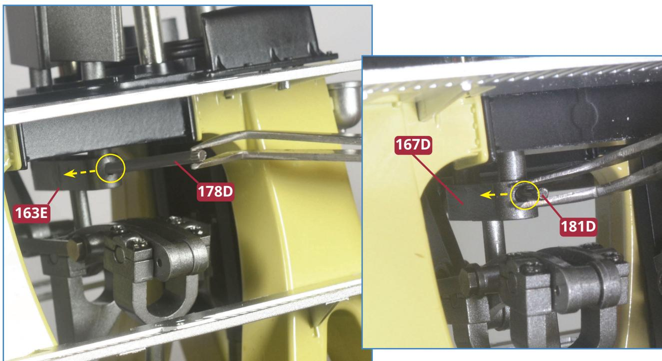
**C** Stellen Sie sicher, dass die Stifte **178D** und **181D** vollständig in ihre jeweiligen Verbindungsstangen **163E** und **167D** eingesteckt sind, damit sie die Bewegung des Motors nicht behindern. Sie müssen beide Seiten der Verbindelemente überprüfen.
