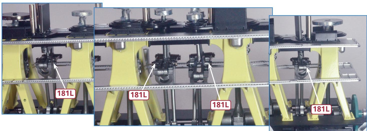
**B** Stellen Sie sicher, dass Sie ausreichend Schmierfett **181L** auf die beweglichen Teile des Motors aufgetragen haben, wie in Ausgabe 181, Schritt 6, beschrieben. Tragen Sie insbesondere großzüig Schmiermittel auf die Verbindungsstangen bzw. Verbindelemente **163E**, **164D**, **166A** und **167D** auf (die Pfeile weisen dorthin). Es kann hilfreich sein, ein geeignetes Kriechöl-Schmiermittel in Sprühdose zu verwenden, wie z. B. WD-40.
