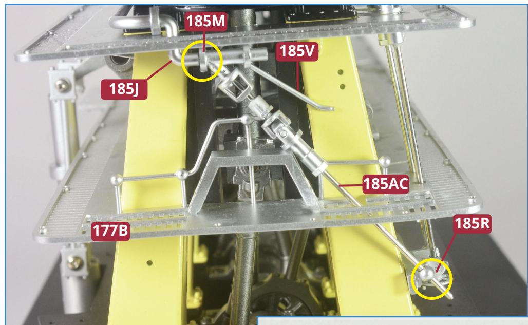
**5** Bringen Sie die soeben zusammengefügte Baugruppe am Ende der Maschine an, wie oben abgebildet: Das Loch des Ventils **185M** nimmt den Zapfen am Ende des Rohrs **185J** auf. Führen Sie die Stange **185AC** durch die Aussparung im unteren Laufgang **177B** und fügen Sie deren Ende in das Kugelement der Aufnahme **185R** ein.
