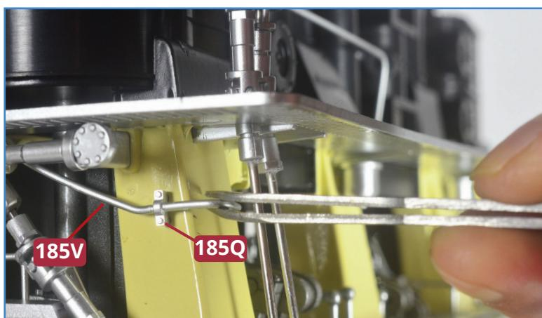
**7** Bringen Sie den Rohrabschnitt **185Q** am freien Ende des Rohrabschnitts **185V** an und fixieren Sie die Teile, indem Sie die beiden Zapfen von **185Q** in die Löcher der Säule einfügen. Kleben Sie das eine Ende des Verbindungsrohrs **185Z** am Rohrabschnitt **185Q** fest. Das andere Ende des Rohrabschnitts wird durch den unteren Laufgang **177B** geführt.
