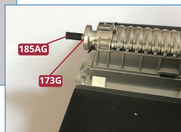
**11** Legen Sie die Klemme **185AE** und die Kurbel **185AF** bereit (links). Platzieren Sie die Klemme **185AE** auf dem Schaft der Kurbel **185AF** (Mitte). Ziehen Sie den Gummischlauch **185AG** über das Ende der Propellerwelle **173G** (rechts).
