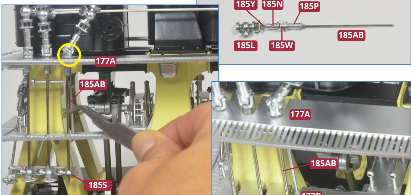
**9** Fügen Sie die Teile **185L**, **185Y**, **185N**, **185W**, **185P** und **185AB** zusammen (wie in Bauanleitung 182, Schritt 5, und Bauanleitung 183, Schritt 4, beschrieben). Führen Sie die Baugruppe von oben zur dritten Aussparung des Laufgangs **177A** (oben eingekreist), sodass die Stange **185AB** beide Läufgänge passiert und durch die Bohrung der Aufnahme **185S** verläuft. Am unteren Ende der Stange wird das Handrad **185T** fixiert (rechts eingekreist).
