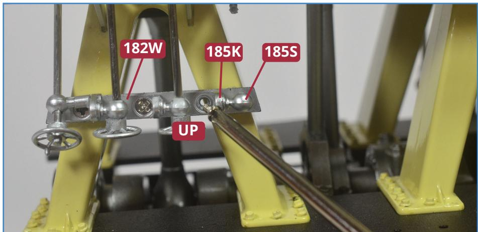
**8** Drücken Sie den Zapfen der Aufnahme **185S** in die Bohrung des Winkels **185K** hinein. Platzieren Sie den Winkel auf der Halteplatte **182W** und fixieren Sie ihn mit einer Schraube **UP**.
