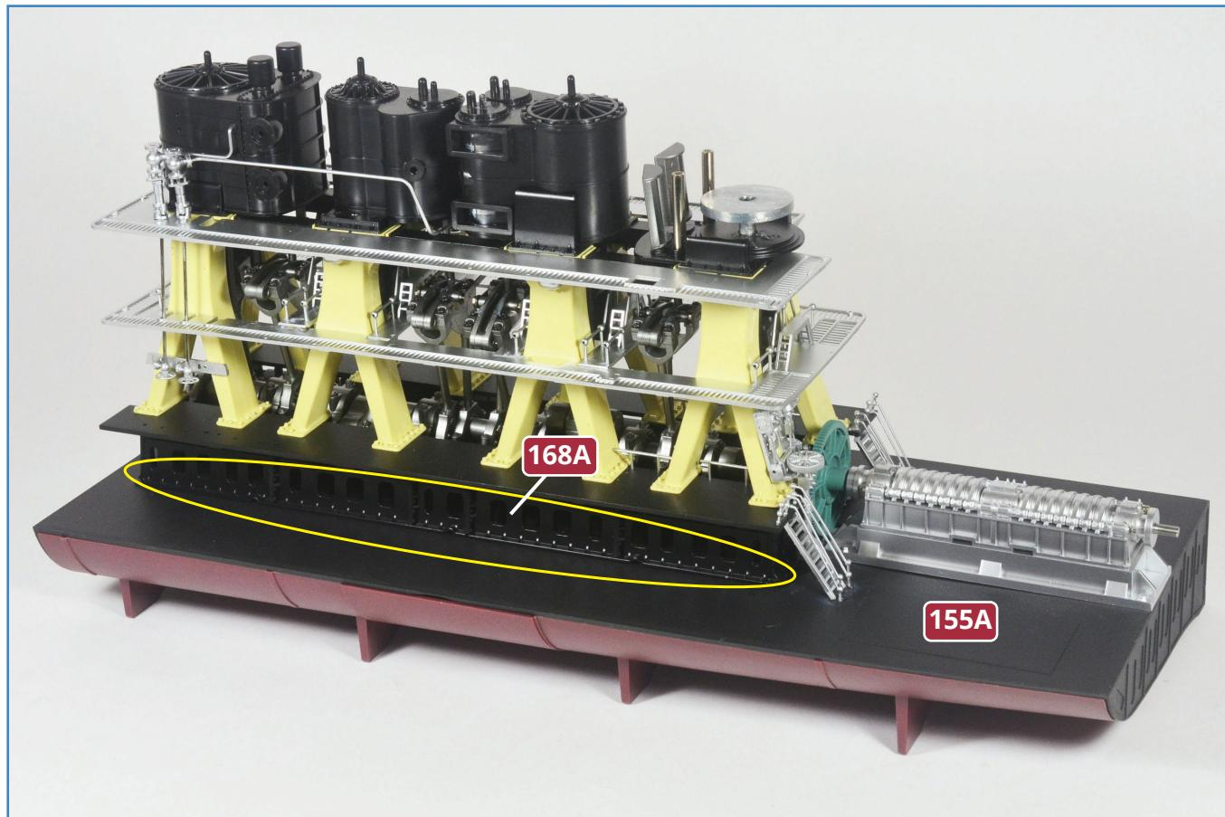
**A** Bevor Sie fortfahren: Stellen Sie sicher, dass auf beiden Motorseiten zwischen der Basis **155A** und der Basis der Säulenstruktur **168A** kein Spalt vorhanden ist (eingekreist). Falls doch, ziehen Sie die Schrauben **VM** (Ausgabe 175) wieder fest.
