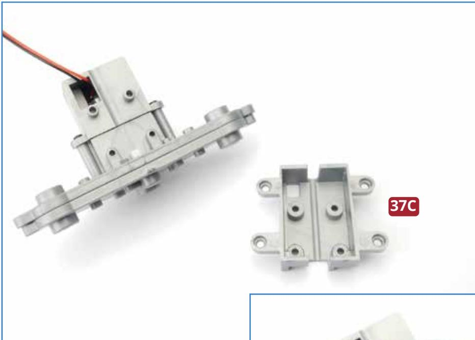
**3** Nehmen Sie die Bodenplatte **37C** und führen Sie das Ende des Motorkabels durch dessen rechteckige Öffnung (rechts eingekreist). Platzieren Sie die Bodenplatte so auf den beiden Gehäuse-Teilen, dass die vier Schraubenaufnahmen fluchten. Fixieren Sie die Bodenplatte mit vier Schrauben **AP** (unten).
