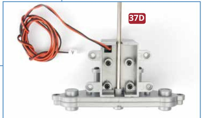
**4** Nehmen Sie die Turbinenwelle **37D** und fügen Sie deren D-förmiges Ende in die Buchse des zentralen Zahnrads ein (oben und oben rechts eingekreist). Drücken Sie die Welle kräftig in die Buchse hinein (rechts).
