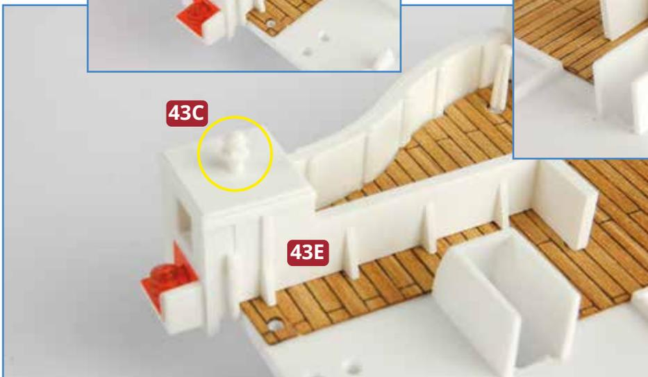
**3** Die beiden Lampen **43C** gehören auf die Dächer der beiden Brückenwände **43E** und **43G**. Geben Sie etwas Sekundenkleber auf die Zapfen der Lampen und kleben Sie sie fest.
