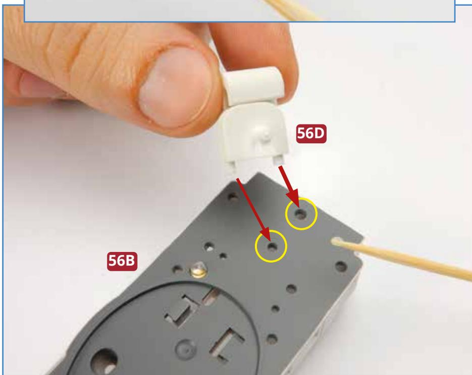
**2** Geben Sie etwas Sekundenkleber auf den D-förmigen Zapfen des Lüfters **56F** und fügen Sie diesen in das entsprechende Loch des Lüftermotors **56D** ein. Anschließend wird der zusammengebaute Lüfter auf der Basis des vierten Schornsteins **56B** festgeklebt. Beachten Sie, dass die beiden Zapfen von **56D** unterschiedlich groß sind, sodass die Ausrichtung des Lüfters vorgegeben ist.
