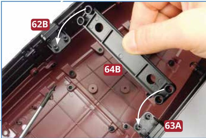
**11** Positionieren Sie die Querver Verstärkung **64B** auf den Winkeln **62B** und **63A**, die an beiden Seiten des Rumpfs montiert sind. Fixieren Sie die Verstärkung mit vier Schrauben **AM**, wie abgebildet.
