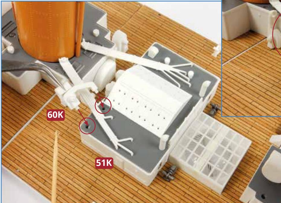
**9** Nehmen Sie den Lüfter **60J/60K**, den Sie mit Ausgabe 60 zusammengebaut haben, und kleben Sie ihn über der Rohrleitung **60M** auf dem Deckshaus **51K** fest.
