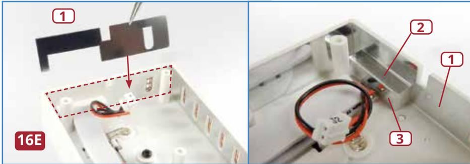
**2** Legen Sie die Aufbaustruktur vorsichtig auf die Seite, sodass Sie auf dessen Unterseite Zugriff haben. Bringen Sie den Klebestreifen **1** an der Innenseite der Rückwand von **16E** an. Die Klebestreifen **2** und **3** gehören auf den benachbarten Vorsprung.
