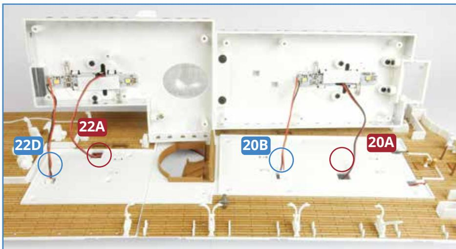
**4** Nun wird die vordere Aufbaustruktur auf das Bootsdeck aufgesetzt. Dazu müssen die Kabel **20B**, **22D** (von den LED-Streifen) sowie die Kabel **20A** und **22A** (von den Schornsteinen) durch die im Bild eingekreisten Löcher im Deck geführt werden.
