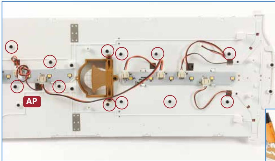
**7** Nun wird die vordere Aufbaustruktur am Bootsdeck befestigt. Verwenden Sie dazu zwölf Schrauben **AP** aus Ausgabe 49: Die Schrauben sind links eingekreist. Achten Sie dabei darauf, dass die Aufbauten und die an ihnen befestigten Kleinteile nicht beschädigt werden.
