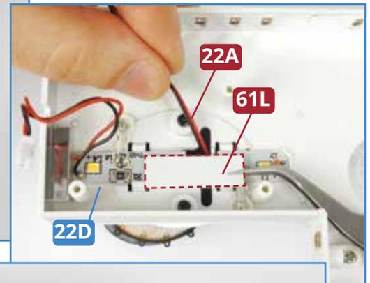
**3** Entfernen Sie die beiden langen Klebestreifen **49E**, die in der 49. Ausgabe auf den LED-Streifen **20B** und **22D** angebracht worden sind. Ersetzen Sie sie durch die beiden kurzen Streifen **61L**, die Sie mit Ausgabe 61 erhalten haben. Positionieren Sie die Streifen **61L** so, dass sie nur die beiden zentralen LEDs der Streifen bedecken, die Kabel **20A** und **22A** aber frei bleiben.
