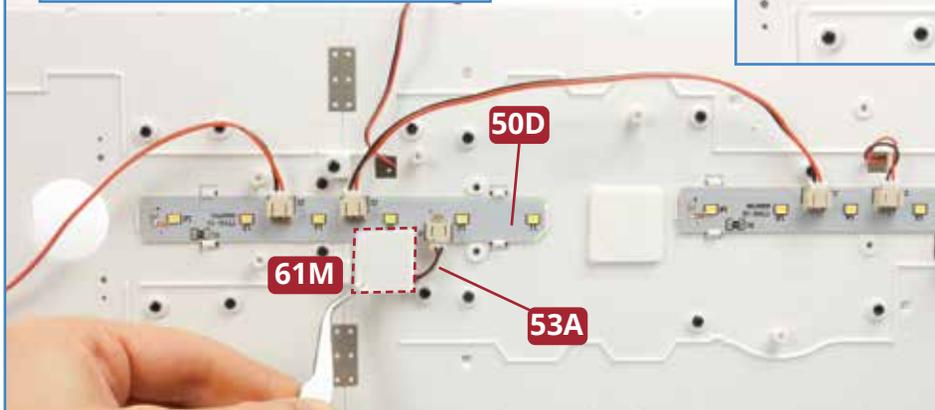
**6** Lösen Sie das letzte Klebequadrat **61M** von der Trägerfolie, die Sie mit Ausgabe 61 erhalten haben. Bringen Sie es so auf dem LED-Streifen **50D** an, dass es das Kabel **53A**, nicht aber die LED verdeckt.
