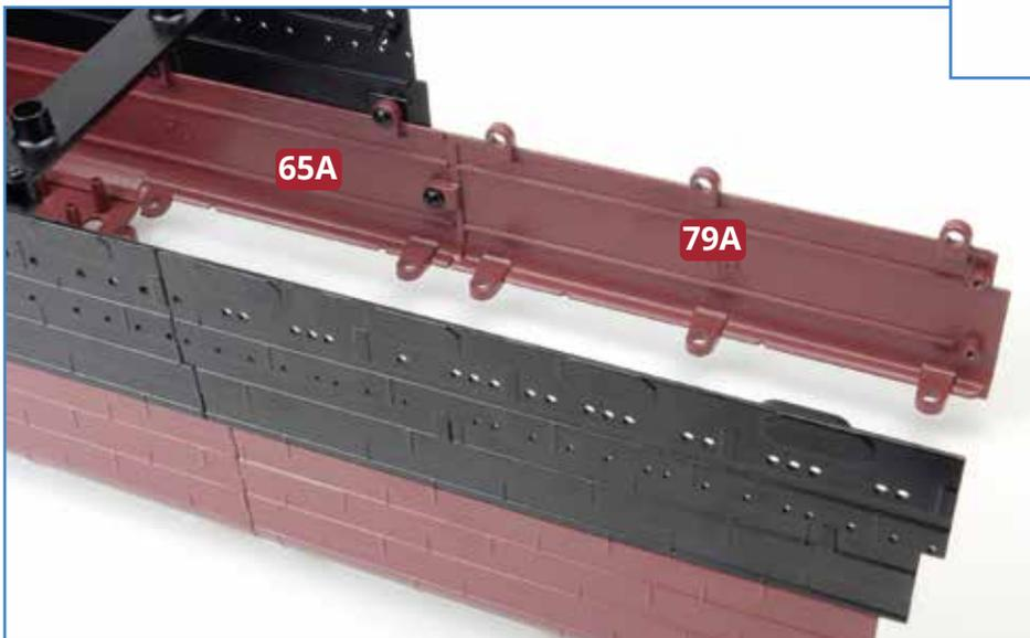
**2** Befestigen Sie den Rumpfabschnitt **79A** mit einer Sechskantschraube **LM** am Rumpfabschnitt **65A**. Wenn Sie die Schraube nicht vollständig festziehen können, fügen Sie eine Unterlegscheibe **79B** ein, wie es oben links angedeutet ist. Verwenden Sie zum Festziehen der Schraube den Inbusschlüssel aus Ausgabe 15.
