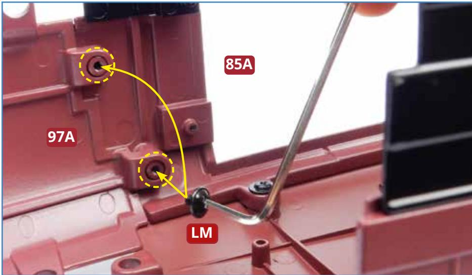
**2** Fixieren Sie den Rumpfabschnitt **97A**, indem Sie zwei Schrauben **LM** mit dem Inbuschlüssel festziehen.
