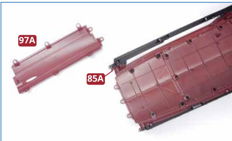
**1** Der Rumpfabschnitt **97A** wird auf der Backbordseite der Rumpfstruktur so mit dem Rumpfabschnitt **85A** zusammengefügt, dass die beiden Laschen des einen Teils die erhöhten Aufnahmen des anderen umschließen (rechts weiß eingekreist).
