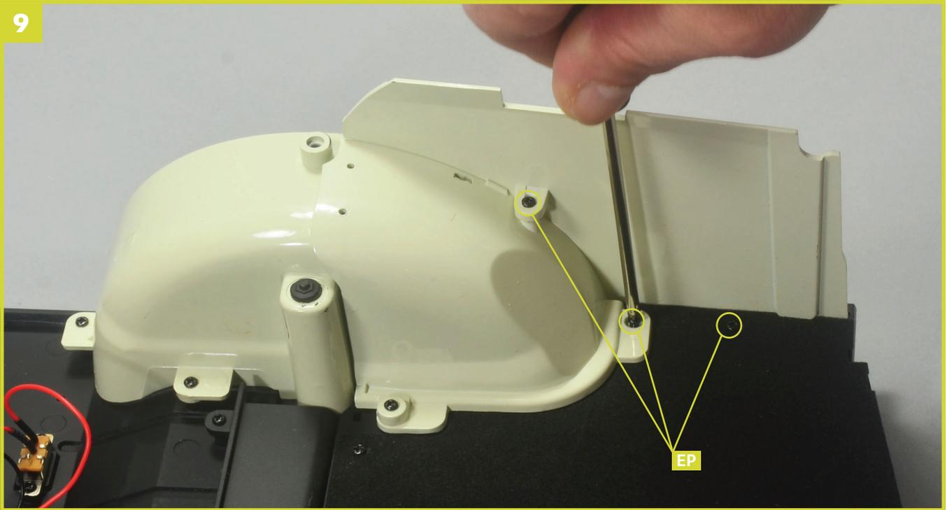
Fixieren Sie die hintere rechte Seitenverkleidung **28C** mit drei Schrauben **EP**.
