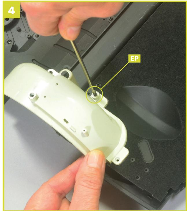
Ziehen Sie eine Schraube **EP** im gezeigten Loch fest, wie auf dem Bild dargestellt.
