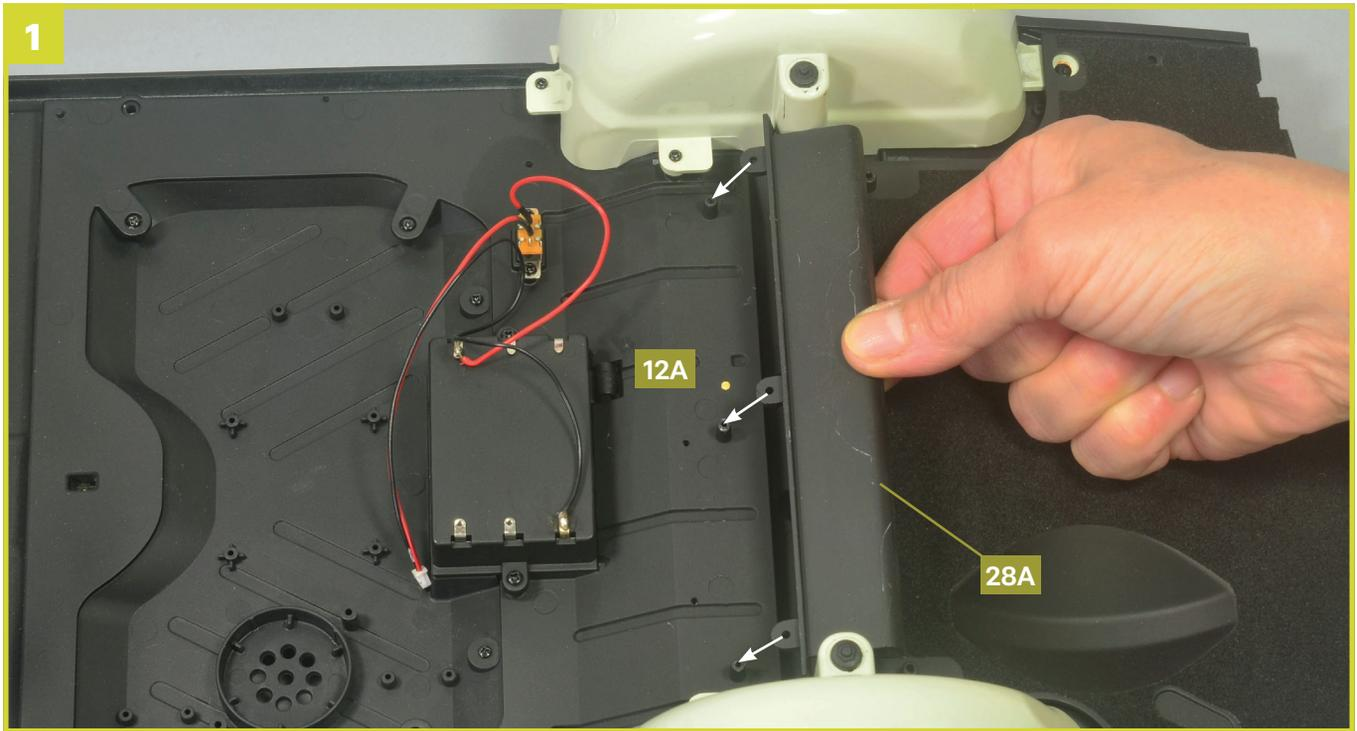
Setzen Sie das Verstärkungsprofil **28A** auf die Zapfen des mittleren Bodenblechs **12A**, wie durch die Pfeile angedeutet.
