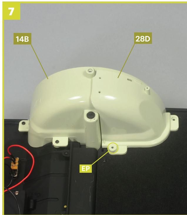
Richten Sie die rechte Radhausschale **28D** über dem rechten hinteren Radkasten **14B** und dem Boden des Kofferraums **26A** aus. Ziehen Sie dann eine Schraube **EP** fest.
