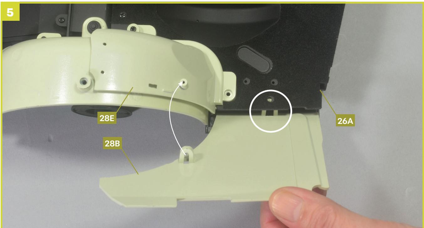
Richten Sie den mit einem Kreis markierten Teil der hinteren linken Seitenverkleidung **28B** wie gezeigt aus und kippen Sie die Seitenverkleidung anschließend so nach oben, dass sie senkrecht zum Boden des Kofferraums **26A** steht.
