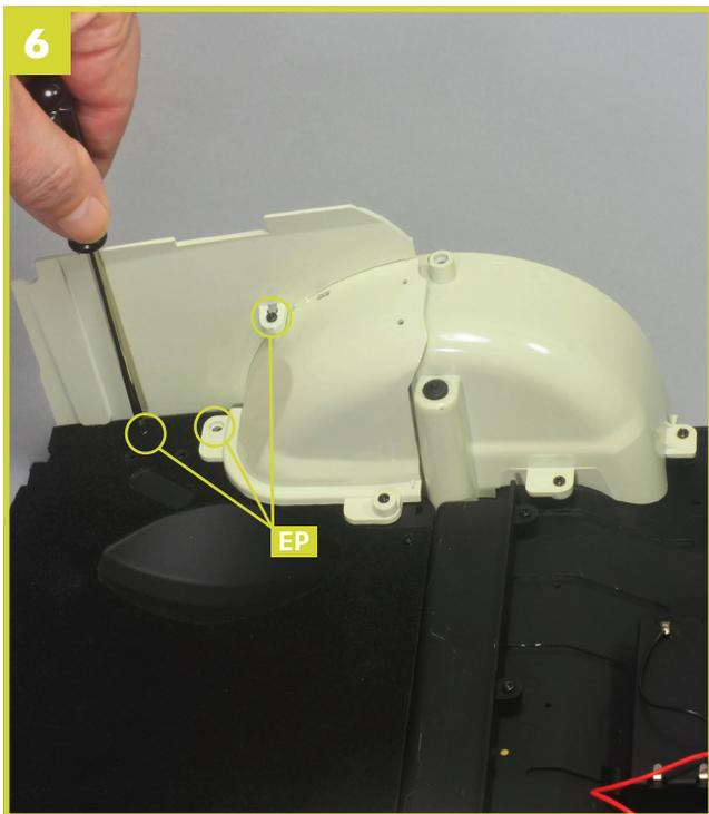
Fixieren Sie die hintere linke Seitenverkleidung **28B** mit drei Schrauben **EP**.
