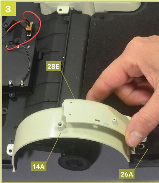
Richten Sie die linke Radhausschale **28E** genau wie auf dem Foto über dem linken hinteren Radkasten **14A** und dem Boden des Kofferraums **26A** aus.
