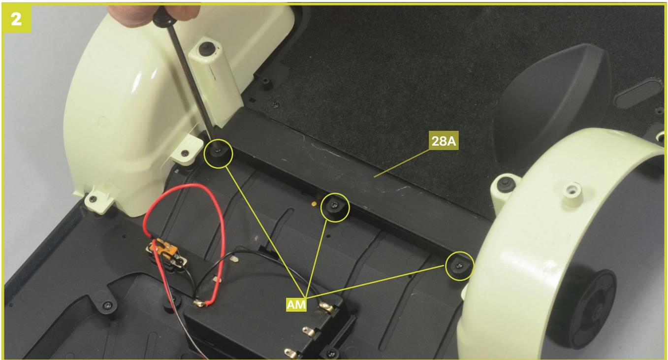
Ziehen Sie drei Schrauben **AM** fest, um das Verstärkungsprofil **28A** am mittleren Bodenblech zu fixieren.
