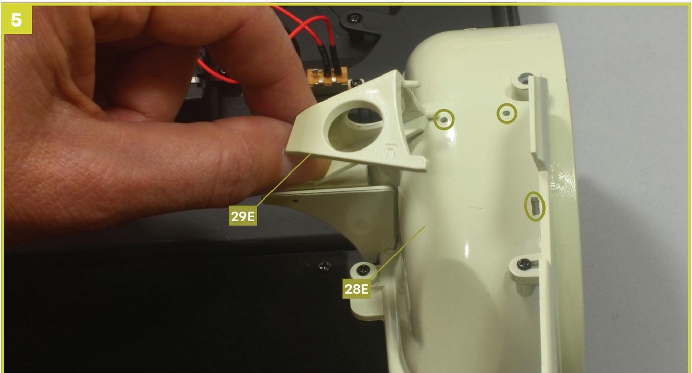
Montieren Sie den rechten Stützbock **29E** an der rechten Radhausschale **28D**, indem Sie ihn in die drei auf dem Bild eingekreisten Verbindungsstellen stecken.
