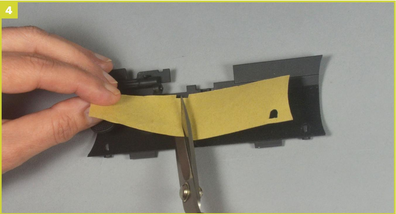
Schneiden Sie mit der Schere die bereits abgelöste Hälfte des Schutzpapiers ab.
