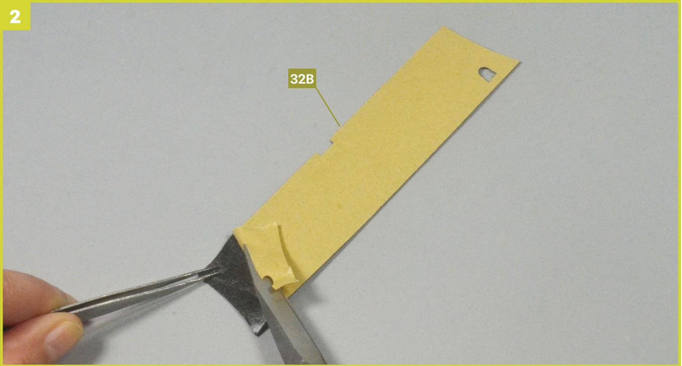
Schneiden Sie den abgelösten Teil des Trägerpapiers vom Bodenbelag **32B** ab.
