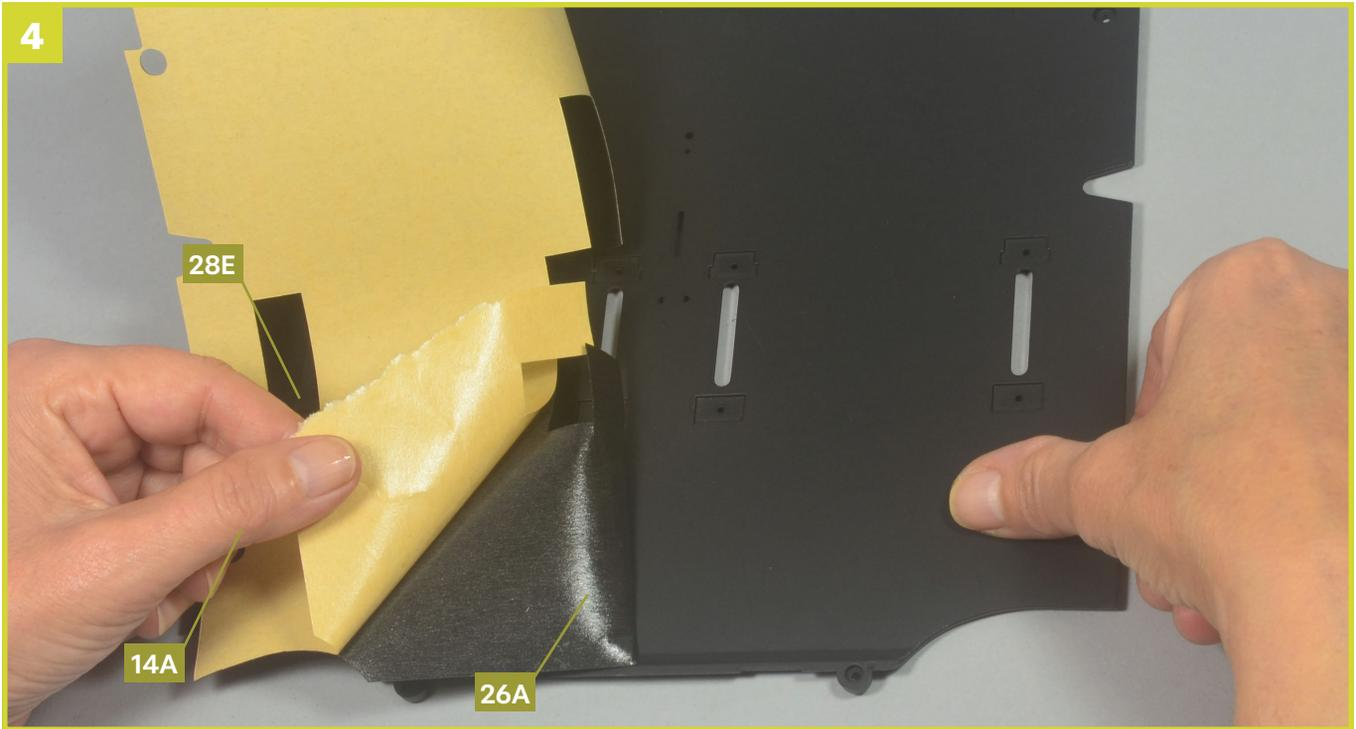
Kleben Sie den Bodenbelag weiter fest, indem Sie das Schutzpapier nach und nach abziehen.
