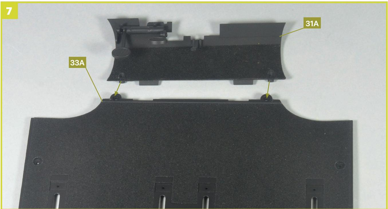
Verbinden Sie nun den Innenteil der Spritzwand **31A** mit dem Boden **33A**, indem Sie beide Teile wie durch die Pfeile angedeutet an ihren Verbindungsstellen zusammensetzen.
