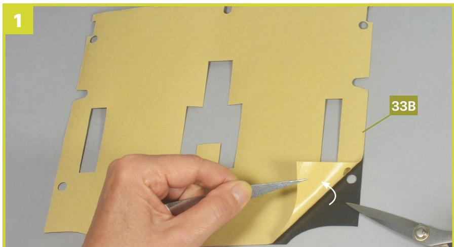
Lösen Sie mit einer Pinzette das Schutzpapier von der im Bild gezeigten Ecke des Bodenbelags **33B** ab.
