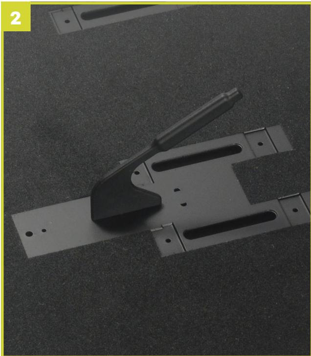
Das Bild zeigt den korrekt montierten Handbremshebel **34A**.
