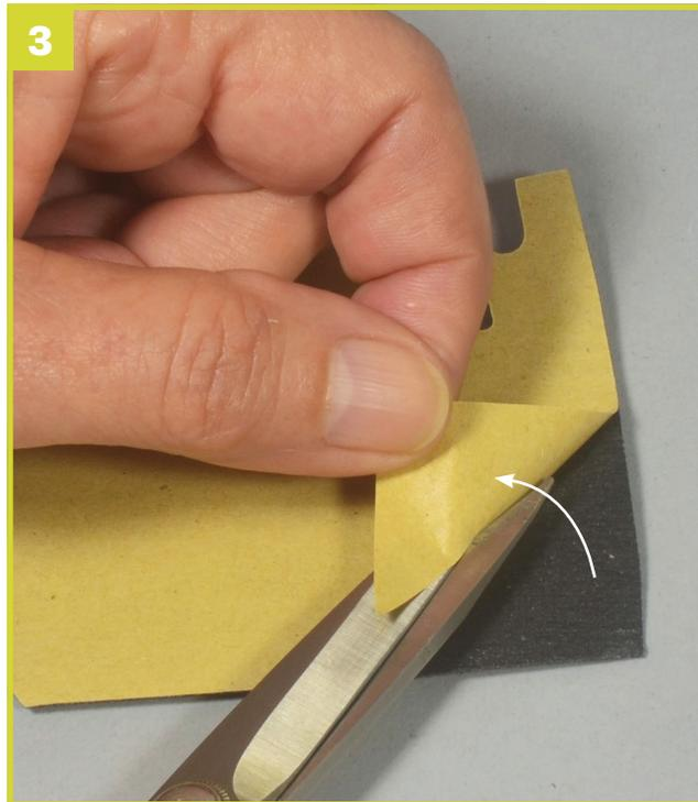
Lösen Sie die gezeigte untere Ecke des Schutzpapiers von der linken Radkastenverkleidung **34B** und schneiden Sie es ab.
