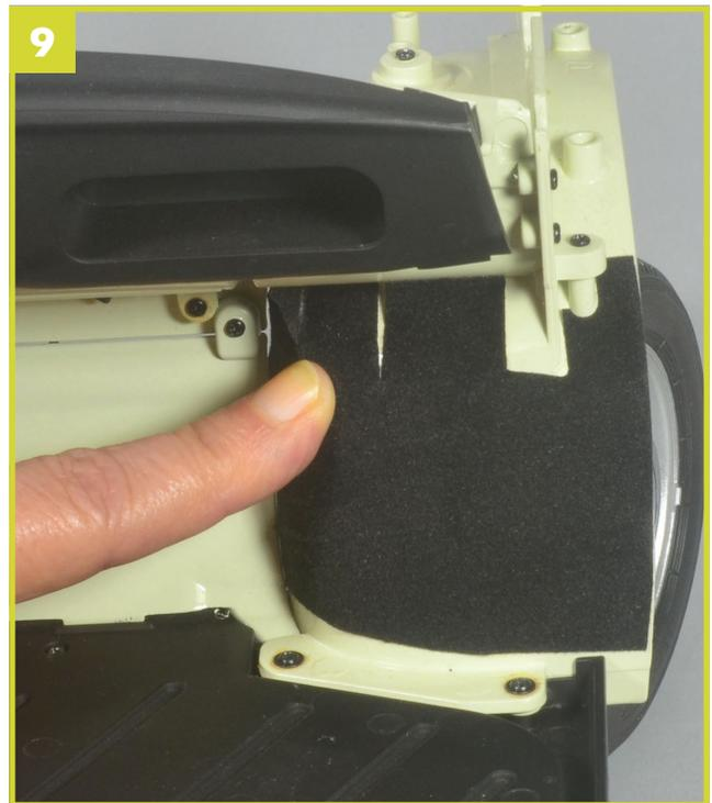
9 Drücken Sie die Radkastenverkleidung mit den Fingern an und bessern Sie eventuelle Unregelmäßigkeiten aus.
