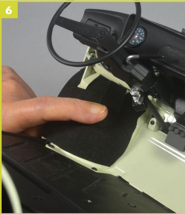
6 Drücken Sie die verlegte Radkastenverkleidung mit den Fingern an und korrigieren Sie eventuelle Unregelmäßigkeiten.
