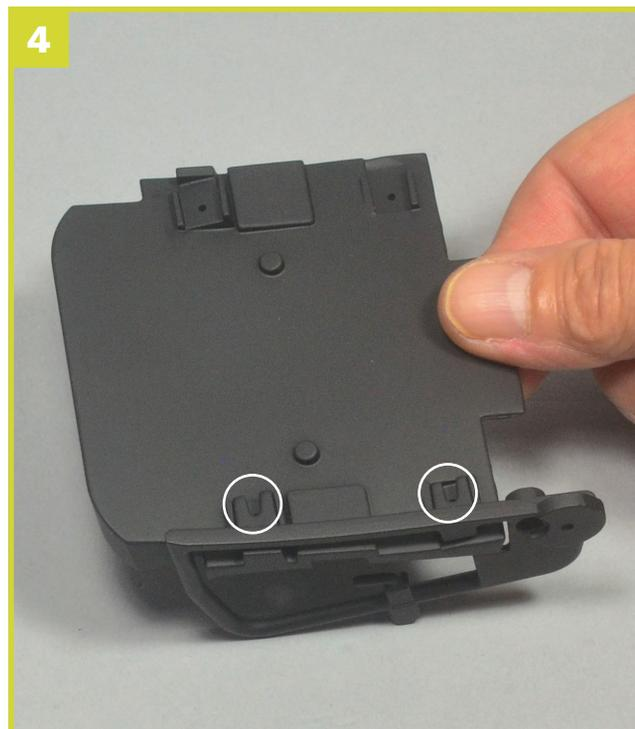
Achten Sie darauf, dass die Schraublöcher (auf dem Bild eingekreist) frei liegen.
