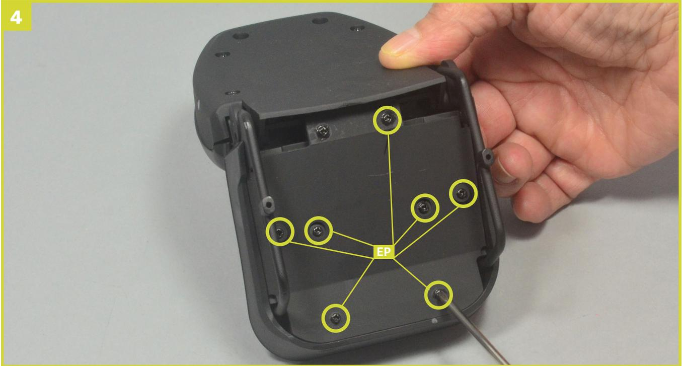
Ziehen Sie sieben weitere Schrauben **EP** in den mittleren Löchern fest, um die Teile zu fixieren.
