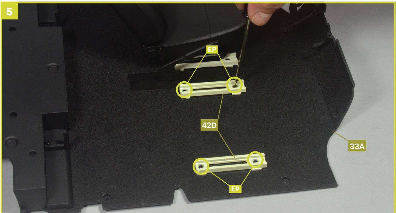
Bringen Sie die beiden Sitzschienen **42D** wie durch die Pfeile angedeutet am Boden (Innenraum) **33A** an, indem sie sie mit vier Schrauben **EP** fixieren.
