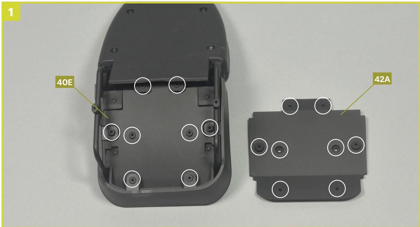
Nehmen Sie die Grundplatte für den Sitz **42A** sowie den unteren Teil des Sitzes zur Hand, den Sie in der letzten Ausgabe gefertigt haben. Setzen Sie beide Teile zusammen, sodass sie an den eingekreisten Verbindungsstellen fluchten.
