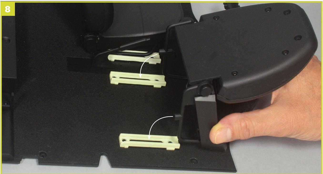
Bringen Sie den Sitz am Boden (Innenraum) **33A** an. Achten Sie dabei darauf, dass die Zapfen der Sitzgestelle **40C** und **40D** in die Aussparungen der beiden Sitzschienen **42D** passen.
