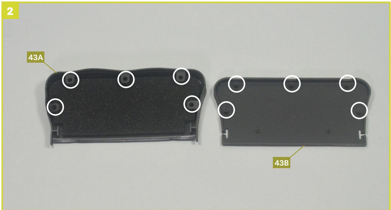
Setzen Sie das Rückszinnenteil **43B** und den Rücksitz **43A** so zusammen, dass sie an den eingekreisten Verbindungsstellen fluchten.
